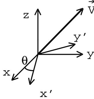
FIG. 2.1 - Rotation (passive) du système d'axes
