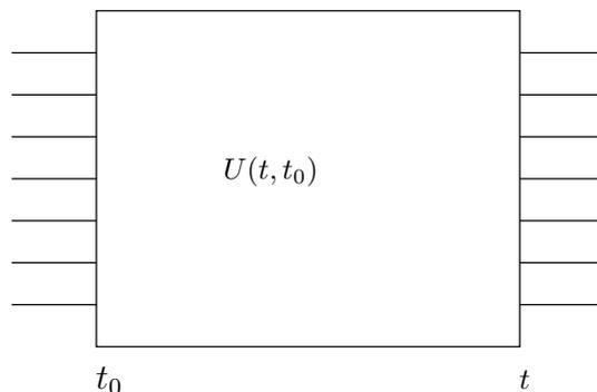
FIG. 4.1 – Schéma de principe d'un calcul quantique :  $n$  qu-bits sont préparés dans l'état  $|0\rangle$ . Ils subissent une évolution unitaire dans l'espace  $\mathcal{H}^{\otimes n}$  de l'instant  $t = t_0$  à l'instant  $t$ , décrite par un opérateur unitaire  $U(t, t_0)$  agissant dans  $\mathcal{H}^{\otimes n}$ . Une mesure des qu-bits est effectuée au temps  $t$ .
