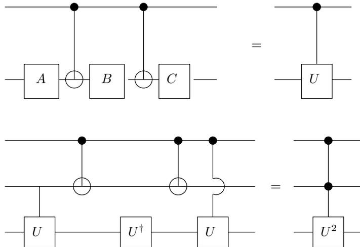
FIG. 4.3 – Construction de la porte cU et de la porte de Toffoli. Les diagrammes se lisent de gauche à droite, alors que les produits d'opérateurs s'effectuent de droite à gauche.
