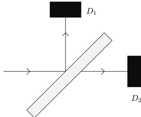
FIG. 1.4 – Lame semi-transparente et détection de photons.
