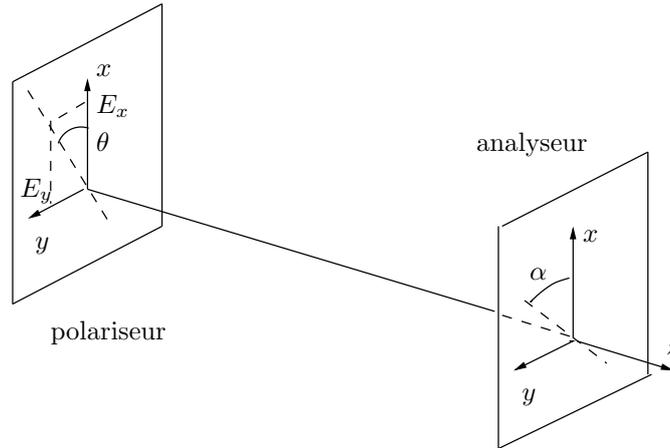
FIG. 1.1 – Ensemble polariseur-analyseur.
