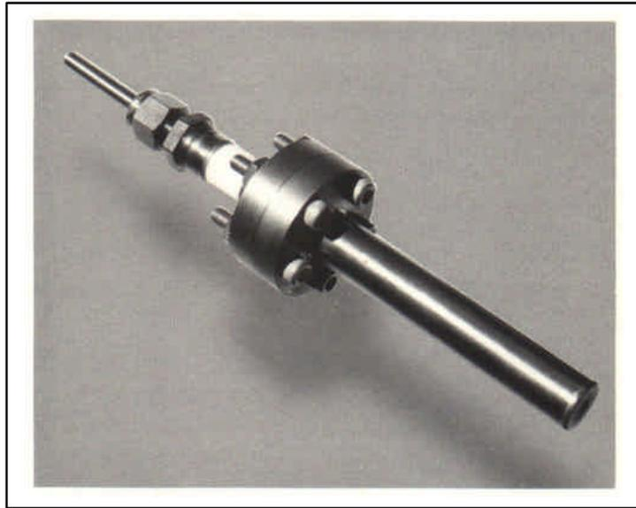
L'immense avantage de ces cathodes concerne la durée de vie ; une cathode métallique délivrant un courant de 1A travaillant à  $10^{-5}\text{mbar}$  ne dure que quelques heures, une cathode à plasma dure plus de 500 heures. Leur utilisation comme neutraliseurs de charge dans les propulseurs ioniques leur a fait connaître, ces derniers temps, un développement considérable qui s'exacerbe avec les nouvelles applications des plasmas à l'aéronautique (radars agiles, propulsion MHD, furtivité,...).
