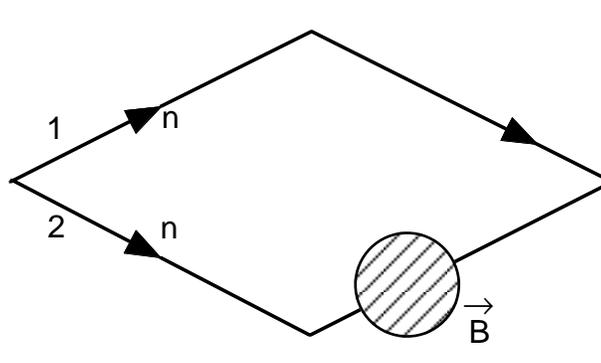
Le principe consiste à séparer un faisceau de neutrons en 2 parties. Le faisceau **2** traverse un champ magnétique  $\vec{B}$ . Au niveau classique (et aussi au niveau quantique !) il y a précession du spin dans le champ. On peut ajuster le temps de passage pour que  $\theta = 2\pi$ . En effet  $\theta = \frac{geBt}{2mc}$  est l'angle dont a tourné le spin dans le champ  $\vec{B}$
