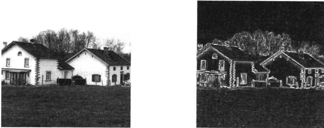
Détection de contours par une convolution de type Sobel
