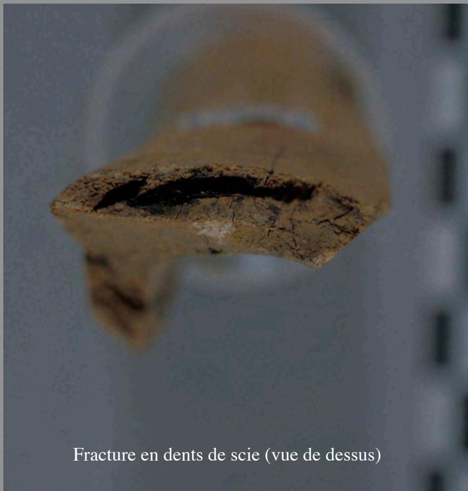
Fracture en dents de scie (vue de dessus)
