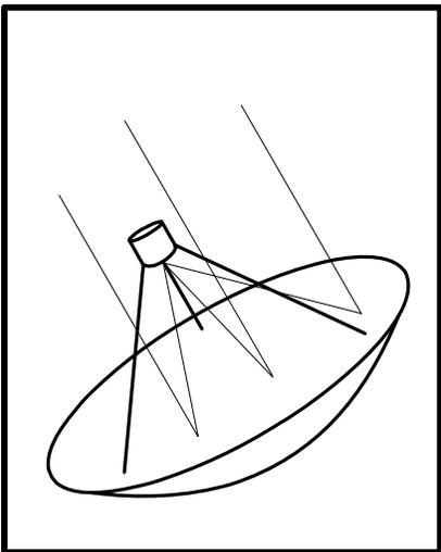
**Figure 17** représente un exemple schématique d'une centrale parabolique. Un miroir parabolique aussi parfait que possible, dans la mesure des contraintes de coûts, focalise les rayons solaires sur un capteur. Avec un miroir de qualité astronomique on arrive à une concentration du rayonnement solaire d'un facteur 10000. Dans la pratique, toutefois, on se satisfait d'un facteur 4000.
