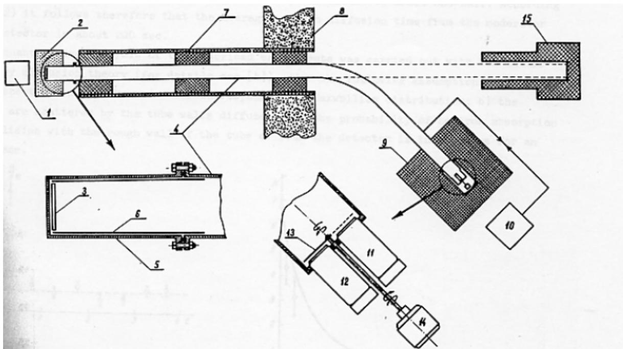
Fig. 1.1. Le schéma de principe de l'expérience. 1 – réacteur ; 2 et 3 – modérateur (2 – paraffine, 3 – une couche fine de polyéthylène) ; 4 – tube en cuivre ; 5 – tube en aluminium ; 6 – tube de cuivre fin ; 7, 9 – blindage ; 8 – mur en béton de réacteur de 2 m d'épaisseur ; 10 – guide courbé ; 11, 12 – détecteurs, 13, 14 – l'interrupteur pour les détecteurs et son mécanisme ; 15 – point d'arrêt du faisceau direct.
