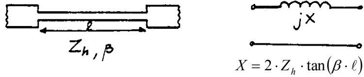
Figure 7.4: Inductance réalisée avec une ligne microruban
