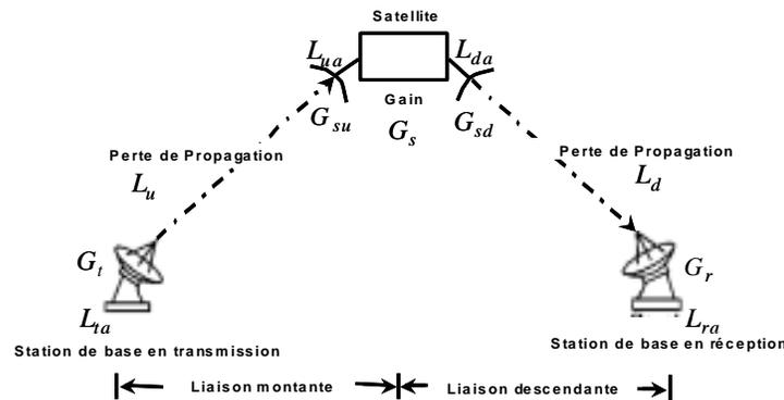
**Figure 1.** Configuration d'un lien de communication par satellite
