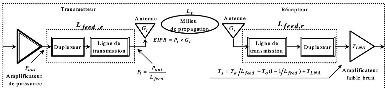
Figure 9. Bloc diagramme simplifié d’une liaison radiofréquence
