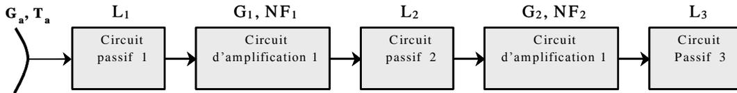
**Figure 7.** Cascade de circuits équivalent d'un récepteur
