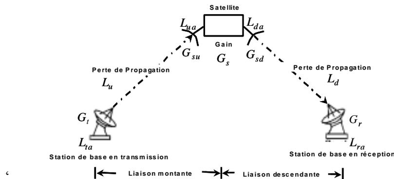
**Figure 6.** Paramètres d'un lien de communication par satellite
