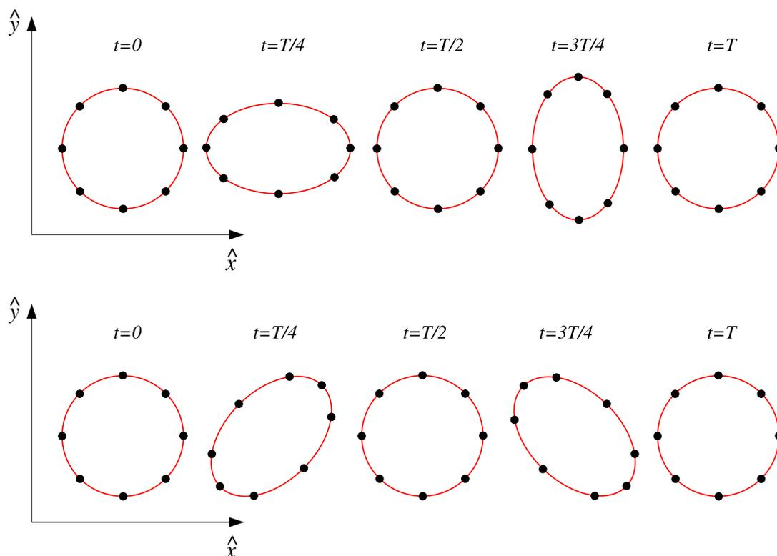
FIG. 6.4 – Déformation d'un cercle de masses ponctuelles par une onde gravitationnelle plane monochromatique (période  $T$ ) se propageant dans la direction perpendiculaire au plan du cercle. Figure du haut : mode de polarisation  $h_+$ , figure du bas : mode de polarisation  $h_\times$ .
