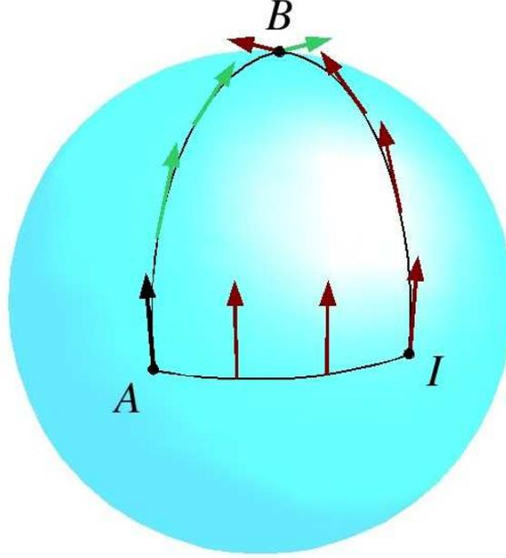
FIG. 4.1 – Transport parallèle d'un vecteur depuis un point  $A$  jusqu'à un point  $B$  en suivant deux chemins différents à la surface d'une sphère : (i)  $A \rightarrow B$  le long d'un méridien, (ii)  $A \rightarrow I$  le long de l'équateur, puis  $I \rightarrow B$  le long d'un méridien. Le vecteur au point d'arrivée dépend du chemin suivi, en raison de la courbure de la sphère.
