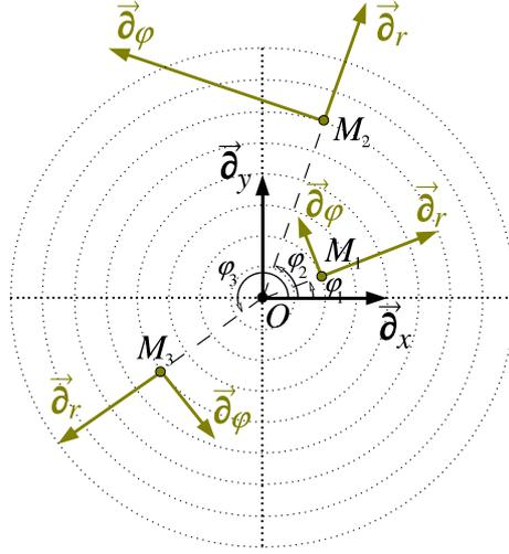
FIG. 2.6 – Vecteurs  $\vec{\partial}_r$  et  $\vec{\partial}_\varphi$  de la base naturelle associée aux coordonnées sphériques, en trois points  $M_1$ ,  $M_2$  et  $M_3$  du plan ( $t = 0, \theta = \pi/2$ ).
