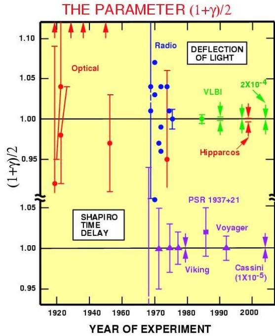
FIG. 3.10 – Résultats de divers tests de la déviation des rayons lumineux (partie haute de la figure) et de l'effet Shapiro (partie basse), représentés à l'aide du paramètre  $\gamma$ , qui vaut 1 en relativité générale [figure tirée de Will (2006) [59]].
