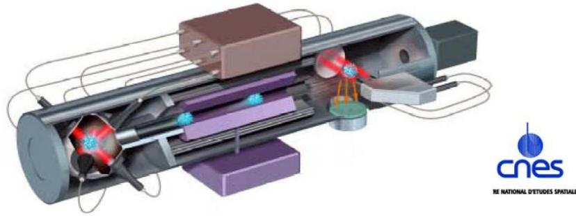
FIG. 3.4 – Schéma de l’horloge à atomes refroidis en microgravité PHARAO, qui doit être installée en 2013 sur la Station Spatiale Internationale, dans le cadre du projet ACES [Source : LKB/SYRTE/CNES].
