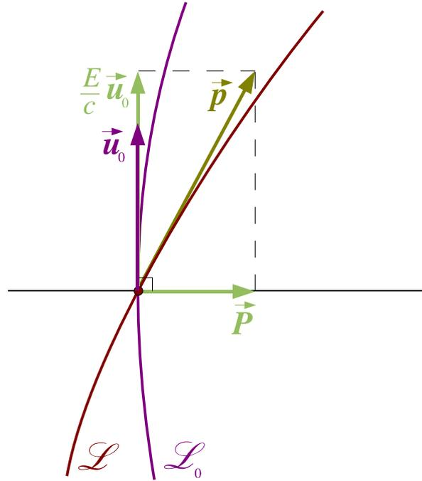
FIG. 2.18 – Énergie  $E$  et vecteur impulsion  $\vec{P}$  d'une particule par rapport à un observateur.  $\mathcal{L}$  est la ligne d'univers de la particule et  $\vec{p}$  son vecteur 4-impulsion.  $\mathcal{L}_0$  est la ligne d'univers de l'observateur et  $\vec{u}_0$  sa 4-vitesse.
