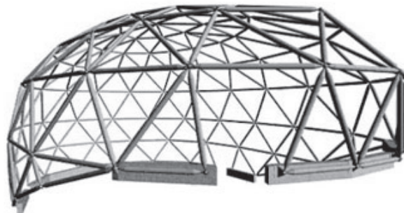
FIGURE 5.1 – Exemple de structure treillis
