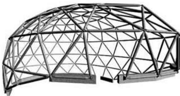
Figure 4.1 - Exemple de structure treillis
