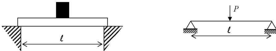
Figure 3.10 - Poutre reposant sur un milieu rigide : cas réel et modélisation
