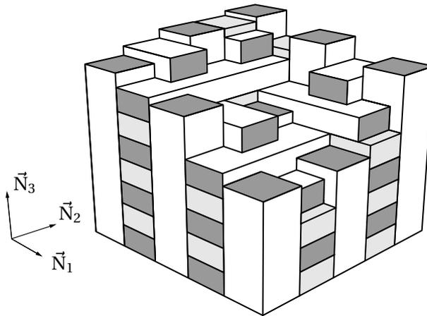
figure 1.7 - Géométrie tri-orthogonale de l'Aerolor 32
