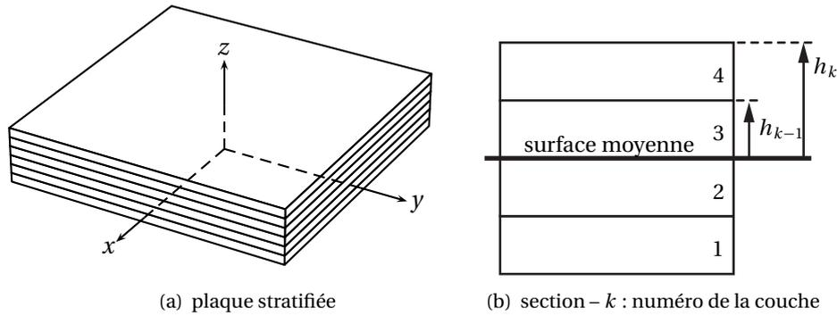
figure 3.1 - Section de plaque stratifiée constituée de couches
