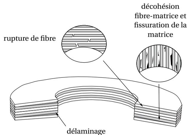
figure 4.1 - Modes de rupture et front de délaminage
