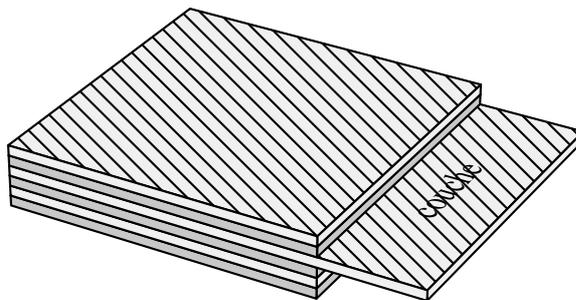
figure 1.3 - Stratifié constitué de couches parfaitement liées
