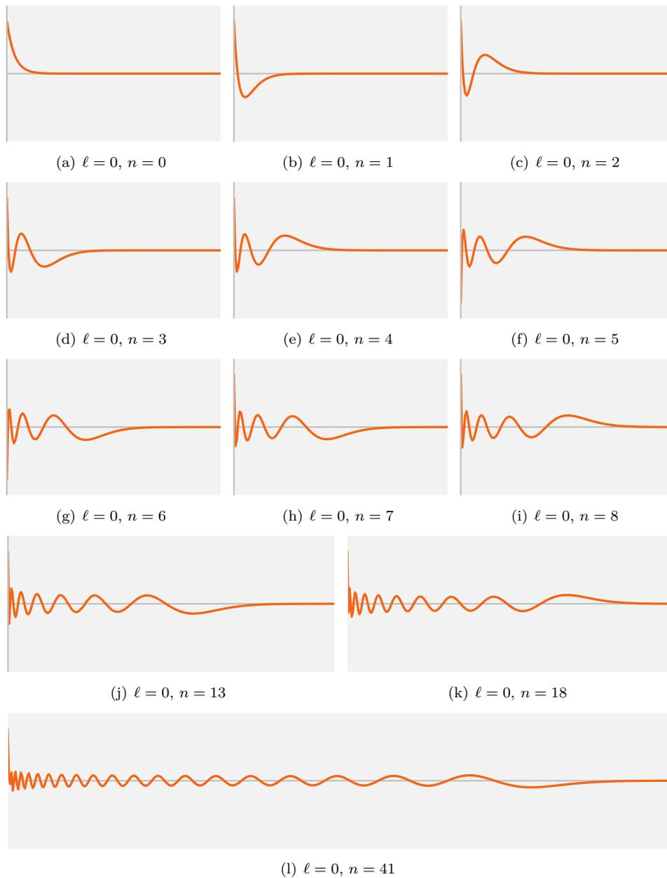
Figure XI.4 – Fonctions de Laguerre  $q_n^0(x) = \frac{1}{n!} e^{-x/2} Q_n^0(x)$ . Les petites fenêtres graphiques ( $n = 0$  à 11) correspondent aux abscisses positives  $x \in [0, 57; 5]$  et aux ordonnées  $y \in [-1, 3; 1, 3]$ . Les fenêtres élargies sont à la même échelle et dévoilent simplement davantage d'abscisses :  $x \in [0, 84; 3]$  pour  $n = 13$ ,  $x \in [0; 100]$  pour  $n = 18$  et  $x \in [0; 200]$  pour  $n = 41$ .
