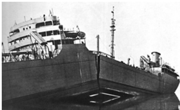
FIGURE 1.9 – Le Schenectady, un des liberty ships entièrement rompus
