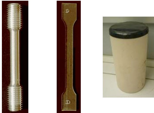
FIGURE 1.1 – Eprouvettes utilisées dans des essais uni-axiaux : à gauche et au milieu, éprouvette cylindrique et éprouvette plate pour un essai de traction ; à droite, éprouvette cylindrique pour un essai de compression.
