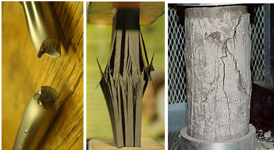
FIGURE 1.6 – Etat final de différentes éprouvettes après un essai uniaxial : à gauche, rupture par striction d'une éprouvette métallique ; au centre, rupture par décohésion des fibres d'un composite à fibres de carbone ; à droite, rupture par fissuration longitudinale d'une éprouvette de béton comprimée.
