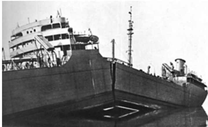
FIGURE 2.9 – Le Schenectady, un des liberty ships entièrement rompus
