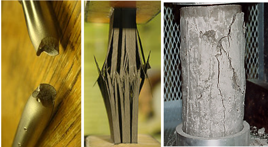
FIGURE 2.6 – Etat final de différentes éprouvettes après un essai uniaxial : à gauche, rupture par striction d’une éprouvette métallique ; au centre, rupture par décohésion des fibres d’un composite à fibres de carbone ; à droite, rupture par fissuration longitudinale d’une éprouvette de béton comprimée.
