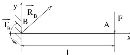
La poutre étudiée et représentée ci dessus est soumise à une force ponctuelle d'intensité  $F$  appliquée en  $A$  et est encastree en  $B$ . On choisira les conventions d'orientation et d'axe de la poutre
