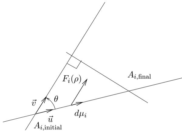
FIG. 3.4. Calcul du travail dû à la force  $F_i$  sur le trajet élémentaire  $d\mu_i$ .
