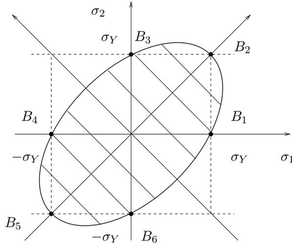
FIG. 6.8. L'ellipse de Von Mises plane.
