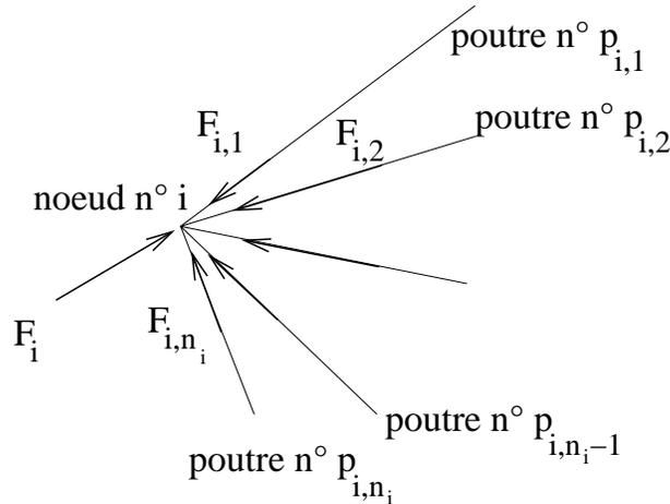
FIG. J.14. Le nœud  $i$  connecté aux poutres de numéro  $p_{i,1}, p_{i,2}, \dots, p_{i,n_i}$  et soumis aux forces  $F_{i,1}, F_{i,2}, \dots, F_{i,n_i}$  exercées par les poutres de numéro  $p_{i,1}, p_{i,2}, \dots, p_{i,n_i}$  et à la force extérieure  $F_i$ .
