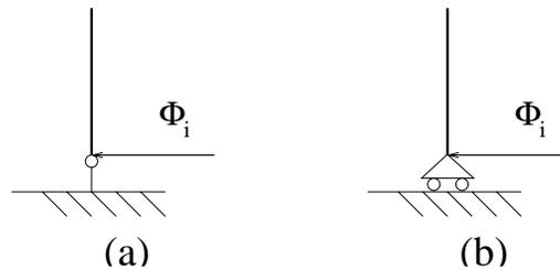
FIG. 3.16. Libération de l'appui associé à un inconnue hyperstatique externe : appui initial (a) et appui libéré (b).
