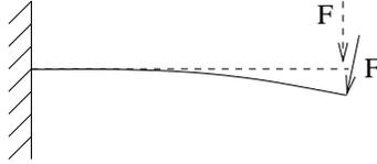
FIG. 3.5. Une structure soumise à une force suiveuse
