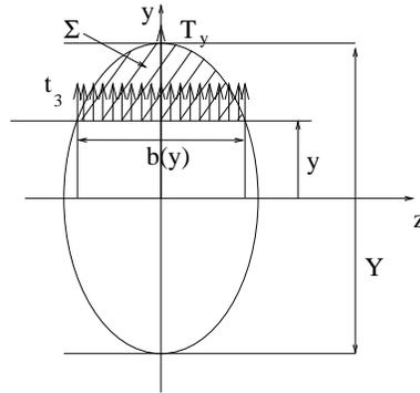
FIG. 1.18. L'effort tranchant et la contrainte  $t_3$
