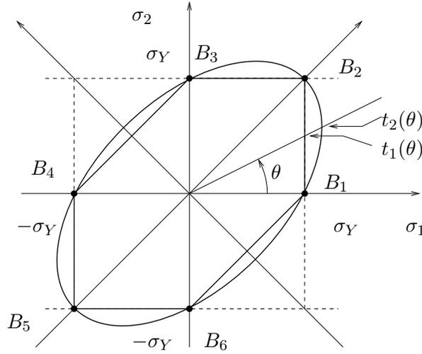
FIG. 6.13. L'angle  $\theta$ ,  $t_1(\theta)$  et  $t_2(\theta)$  pour l'ellipse de Von Mises plane et l'hexagone de Tresca plan.
