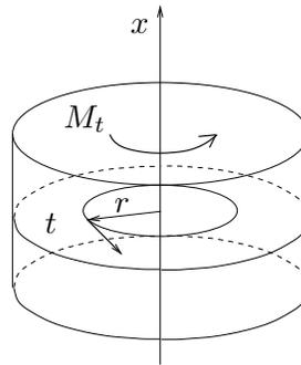
FIG. 1.20. La contrainte tangentielle en torsion libre
