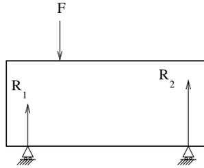
FIG. 3.8. Structure extérieurement isostatique et intérieurement hyperstatique.
