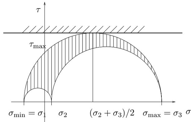
FIG. 6.3. La contrainte dans le plan de Mohr.
