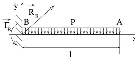
La poutre étudiée n'est soumise qu'à son poids  $P$  (on note  $p = P/l$  son poids linéique) et est encadrée en  $B$ . On choisira les conventions d'orientation et d'axe de la poutre comme indiqué sur la figure (les axes locaux de la poutre sont semblables aux axes globaux). On note respectivement  $\vec{R}_B$  et  $\vec{\Gamma}_B$  la résultante et le moment de la réaction d'appui au point  $B$ .
