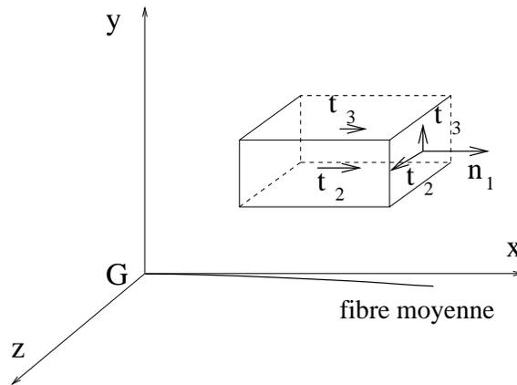
FIG. 1.6. Nullité des contraintes  $n_2$ ,  $n_3$  et  $t_1$
