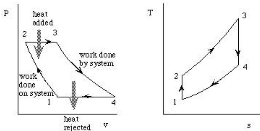
On introduit deux rapports : le rapport thermique de compression  $\lambda = \left(\frac{P_2}{P_1}\right)^{\frac{\gamma-1}{\gamma}}$  et le rapport des températures  $\tau = \frac{T_3}{T_1}$
