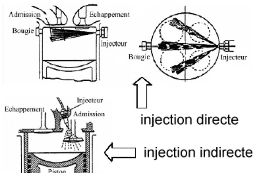
L'alimentation par **injection directe** d'essence sous haute pression dans le cylindre est de plus en plus pratiquée.
