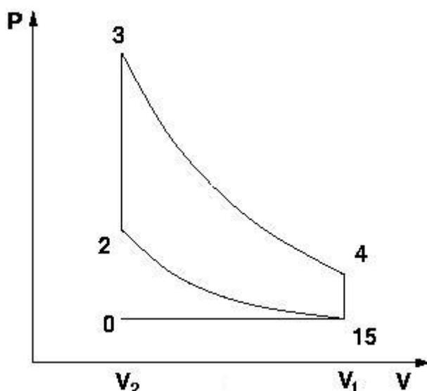
Remarque : la pression au point 4, la pression d'échappement, est supérieure à la pression atmosphérique. Le cycle rejette des gaz encore valorisable par une détente.
