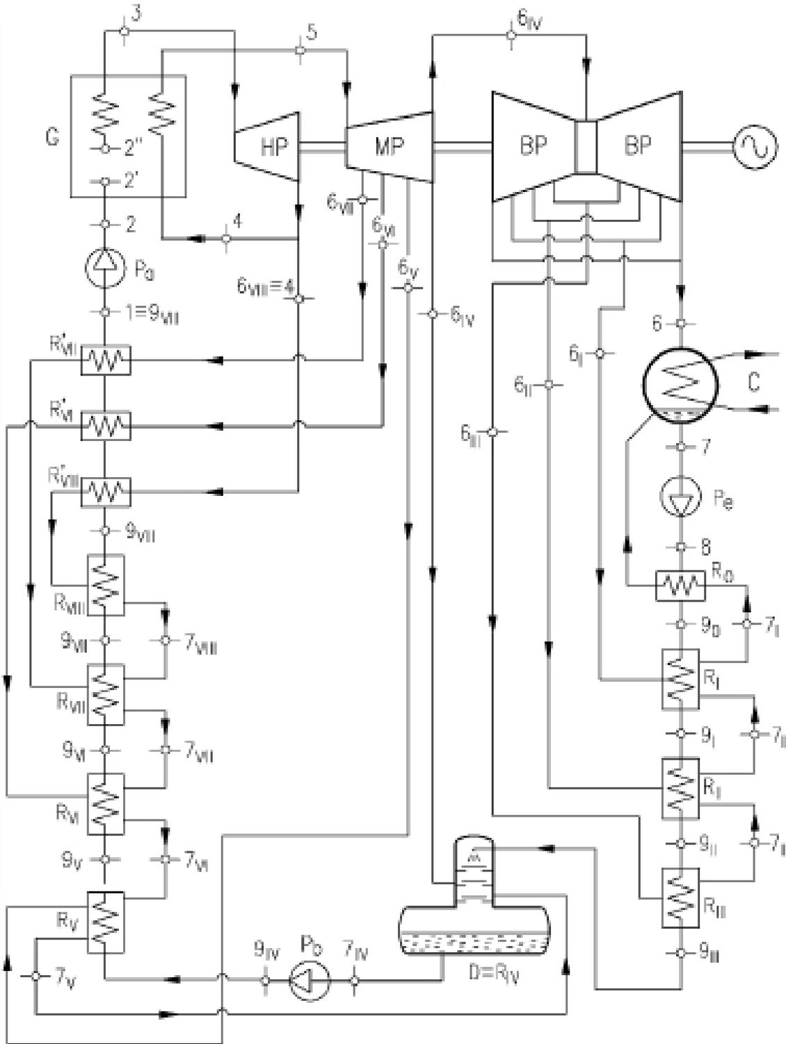
FIG. VI.6 – Cycle complexe d’une turbine à vapeur
