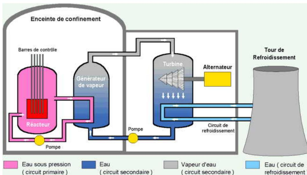
FIG. VI.8 – Schéma d'un réacteur de typer REP
