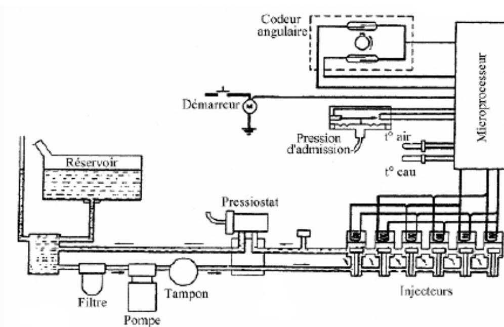
FIG. V.3 – Schéma système d'injection moteur essence
