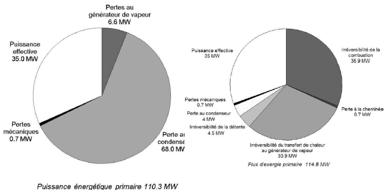
FIG. VI.4 – Bilan d’une installation à vapeur simple
