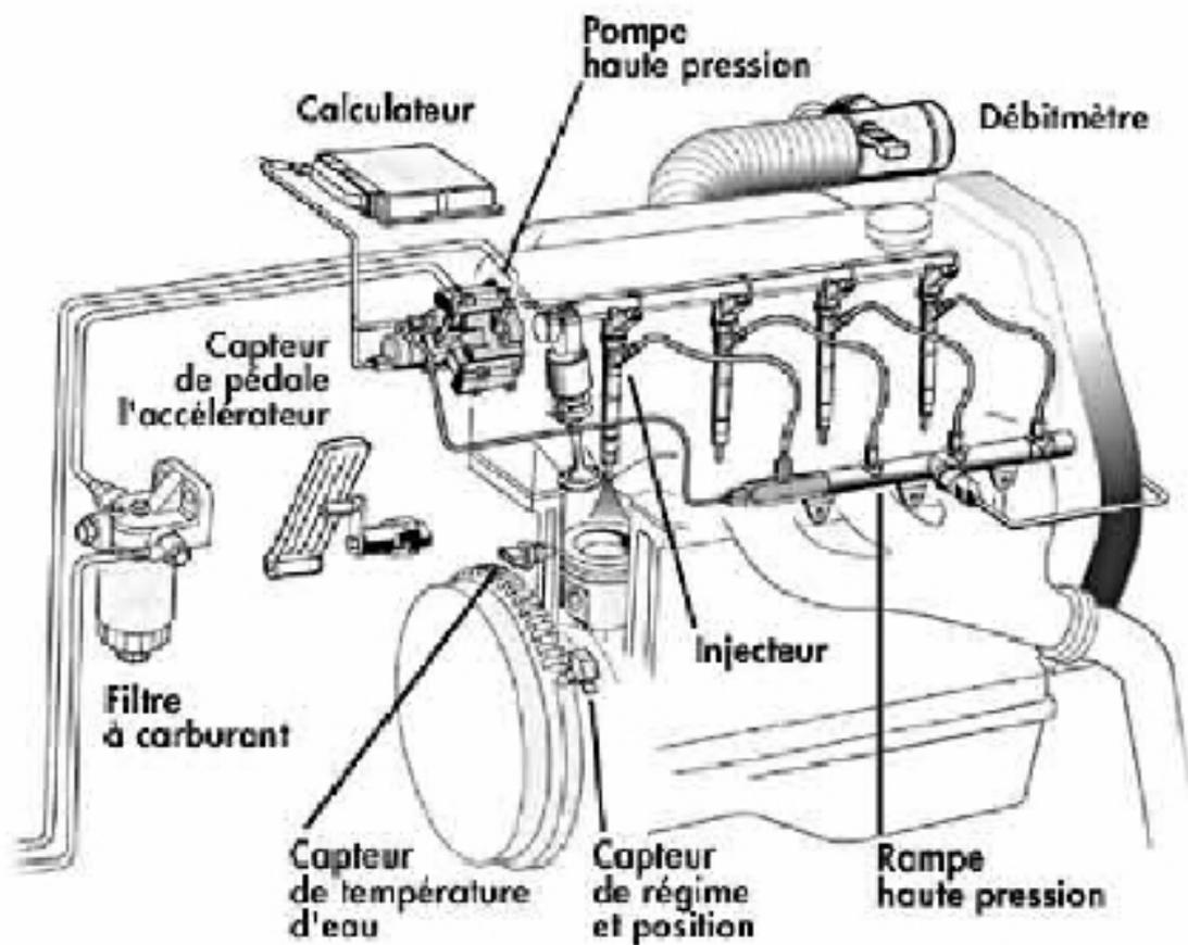
FIG. V.5 – Système common rail - moteur Diesel
