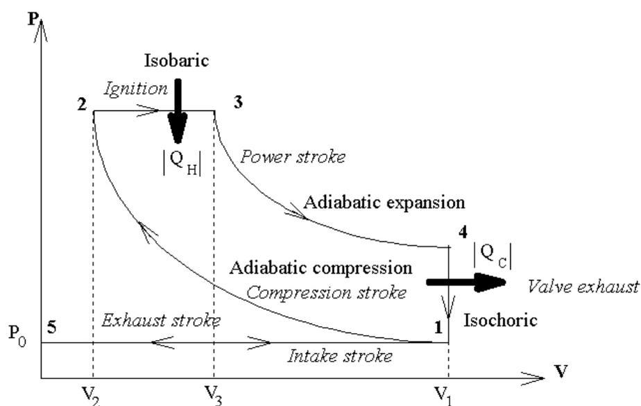
Données : le rapport volumétrique de compression :  $\rho = V_1/V_2$  et le rapport des volumes dans la combustion :  $\varepsilon = V_3/V_2 = T_3/T_2$ .
