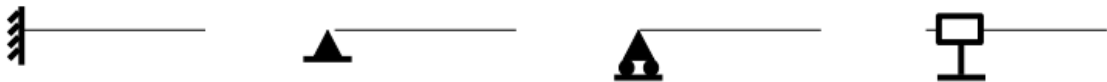
FIGURE 4.2 – La symbolique des liaisons 2d utilisée dans ce cours (non normalisée) de gauche à droite : encastrement 2d, appui simple 2d, appui sur rouleau 2d, glissière 2d
