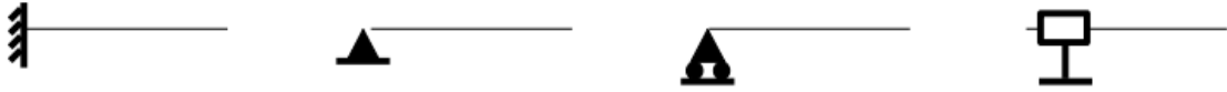
Figure 5.2: La symbolique des liaisons 2d utilisée dans ce cours (non normalisée) de gauche à droite : encastrement 2d, appui simple 2d, appui sur rouleau 2d, glissière 2d
