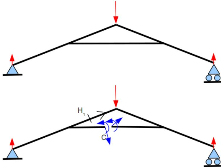
FIGURE 3.35 – Un système hyperstatique intérieurement nécessite d'effectuer une coupure en un point arbitraire C.
