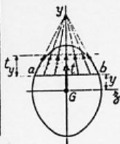
Le long d'une ligne parallèle à l'axe d'inertie  $Gz$  d'ordonnée  $y$ , coupant le contour de la section aux deux points  $a$  et  $b$  :
