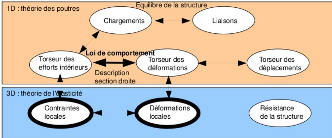
FIGURE 3.20 – Les concepts utiles à la détermination à venir de la loi de comportement de la fibre moyenne.
