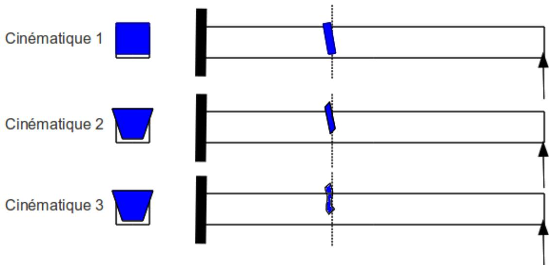
FIGURE 3.21 – Les trois cinématiques des sections droites envisagées, illustrées dans le cas d'une poutre de section droite rectangulaire, sollicitée en flexion et effort tranchant.
