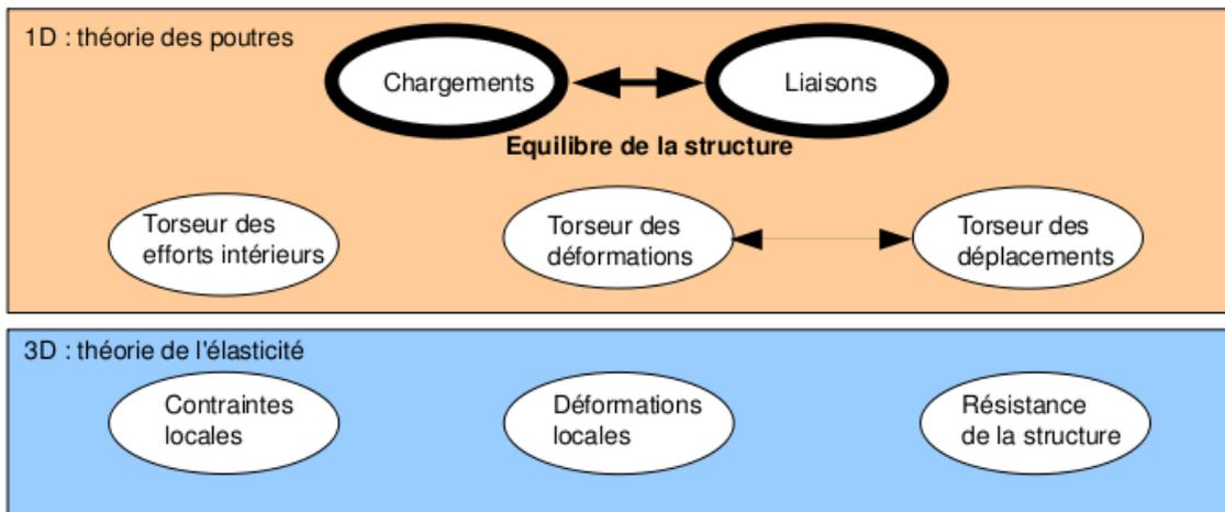
FIGURE 3.6 – Les concepts utiles à la détermination du degré d'hyperstatisme et des réactions aux liaisons.
