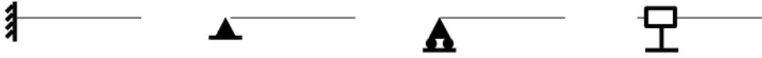
Figure 4.2: La symbolique des liaisons 2d utilisée dans ce cours (non normalisée) de gauche à droite : encastrement 2d, appui simple 2d, appui sur rouleau 2d, glissière 2d
