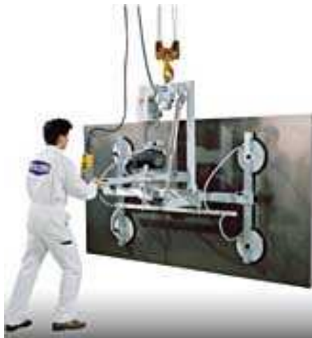
Figure 1.43: Un système de levage par ventouses.
