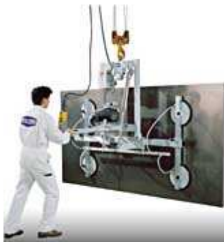
Figure 1.71: Un système de levage par ventouses.
