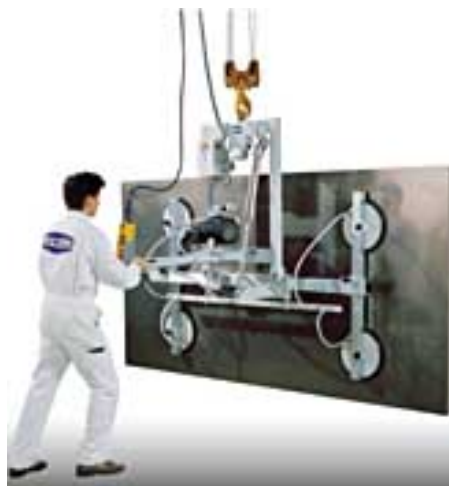
FIGURE 1.31 – Un système de levage par ventouses.
