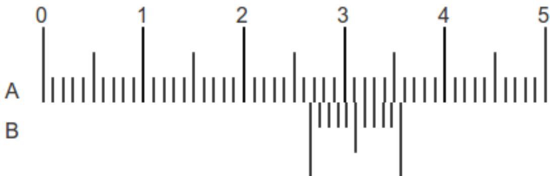
Figure 1.3: Curseurs d'un pied à coulisse
