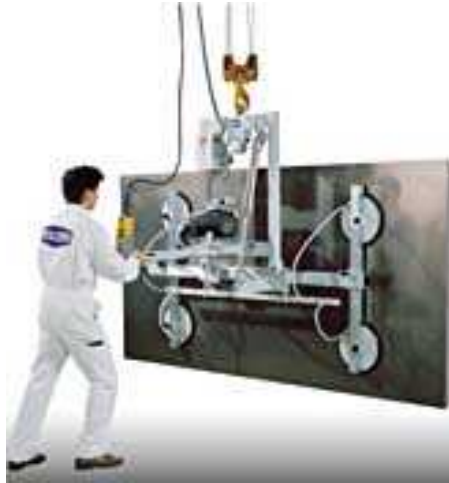
Figure 1.92: Un système de levage par ventouses.
