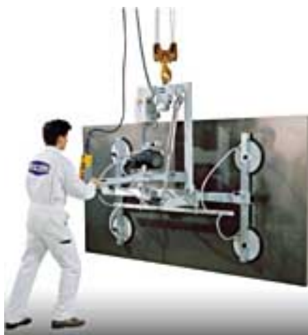
FIGURE 1.31 – Un système de levage par ventouses.
