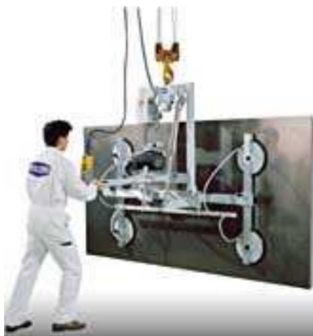
FIGURE 1.34 – Un système de levage par ventouses.
