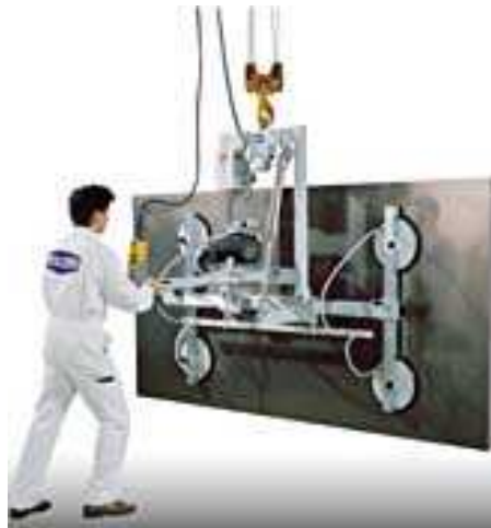
Figure 1.37: Un système de levage par ventouses.
