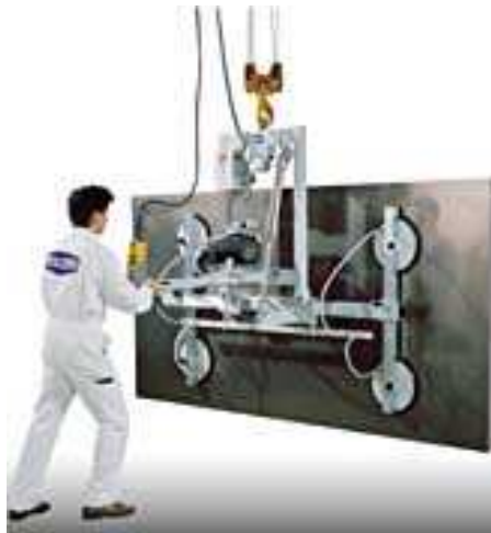
Figure 1.37: Un système de levage par ventouses.
