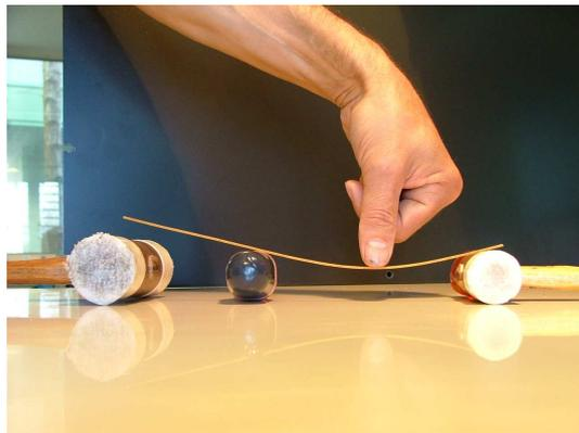
FIGURE 2.7 – Un exemple de système hyperstatique.
