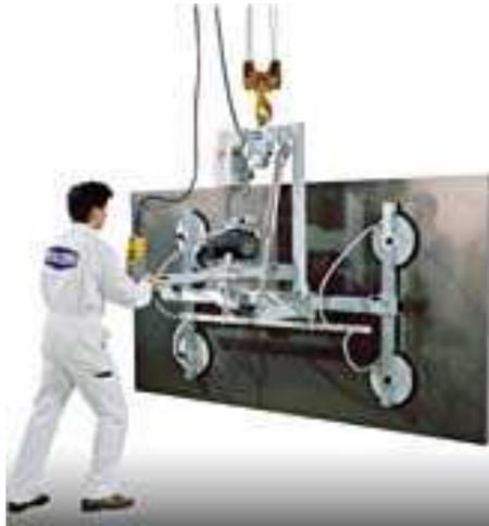
FIGURE 1.37 – Un système de levage par ventouses.
