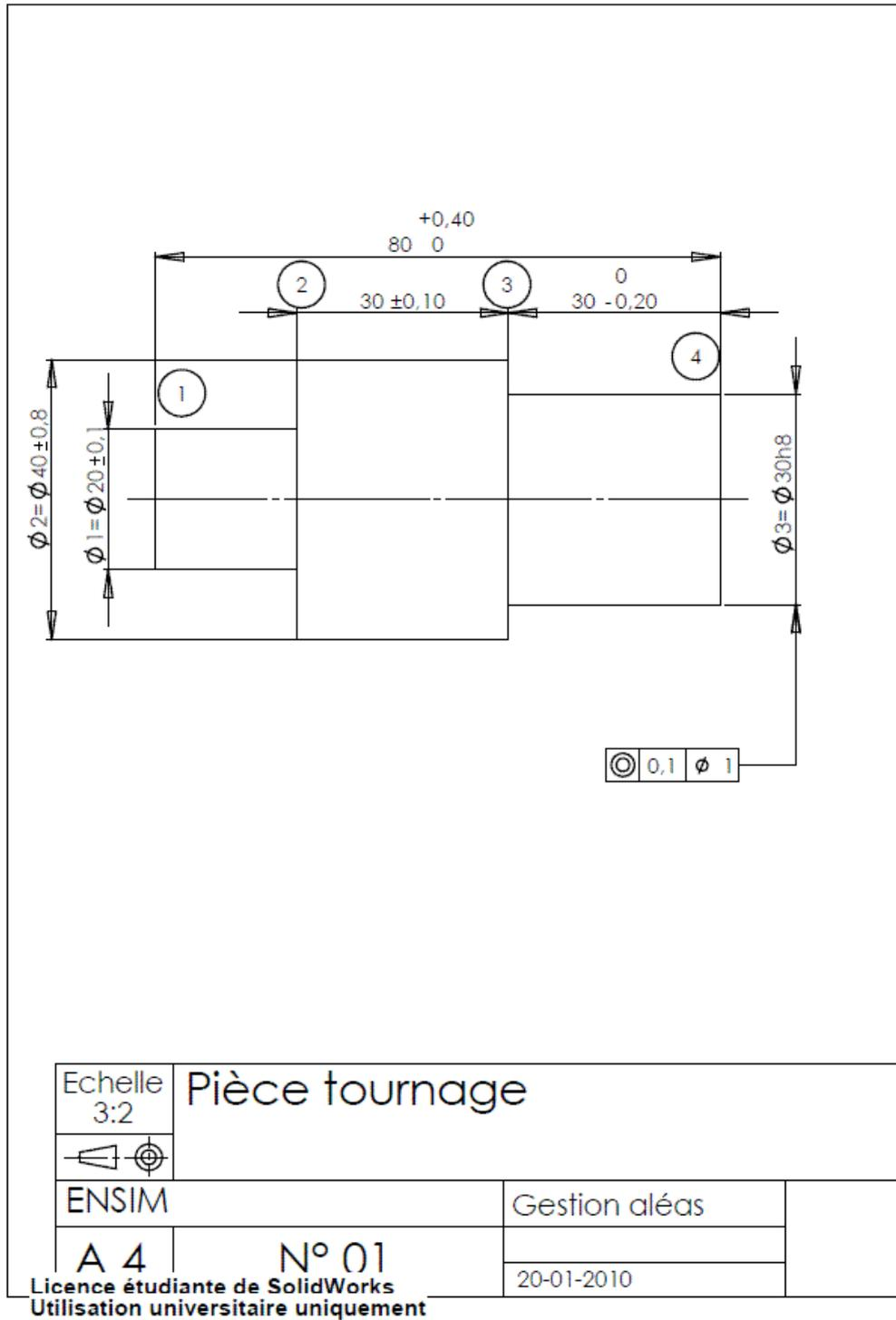
FIGURE 1.7 – Dessin de définition d'une pièce à fabriquer.
