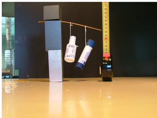
FIGURE 2.15 – Une poutre soumise à un chargement 1 et 2.
