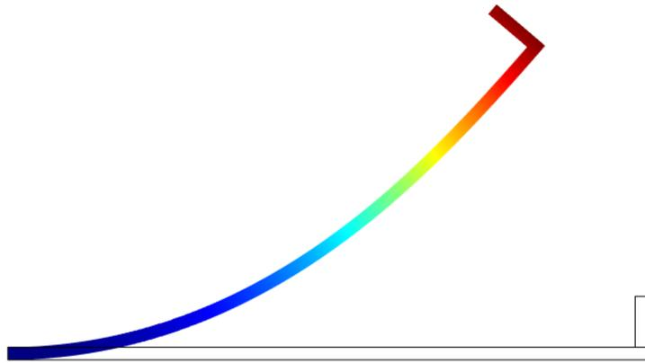
FIGURE 2.25 – Calcul d’une déformée en grands déplacements.
