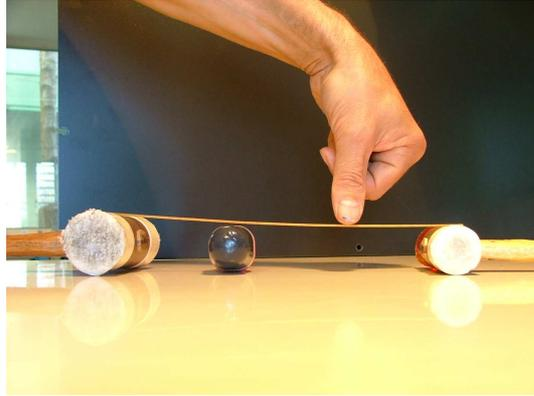
FIGURE 2.6 – Un exemple de système hyperstatique.
