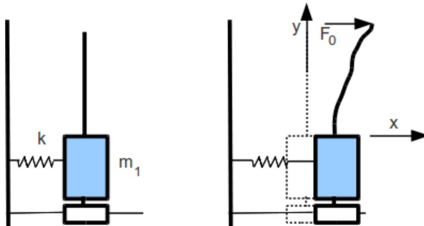
FIGURE 1.15 – équilibrage dynamique d'une structure
