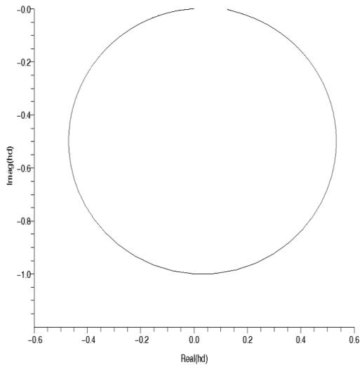
FIGURE 1.24 – Nyquist d’une fonction de réponse en fréquence.
