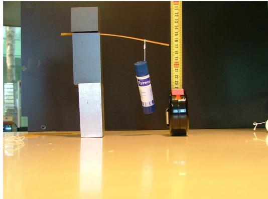
FIGURE 2.14 – Une poutre soumise à un chargement 2.
