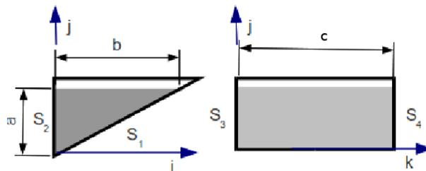
FIGURE 1.36 – Un demi parallélépipède remplis partiellement de fluide.
