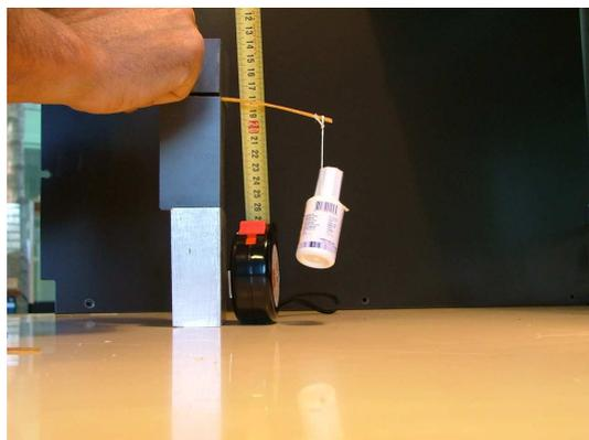
FIGURE 2.16 – Une poutre soumise à un chargement 1.
