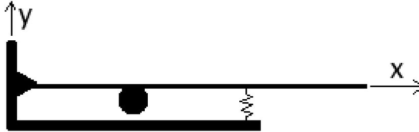
FIGURE 1.17 – Poutre articulée avec masselotte et rigidité extérieure.
