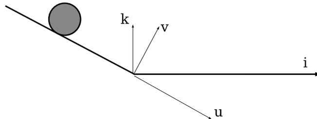
Figure 4.5: Un essai de lâcher d'une bille pour mesurer le coefficient de résistance au roulement.
