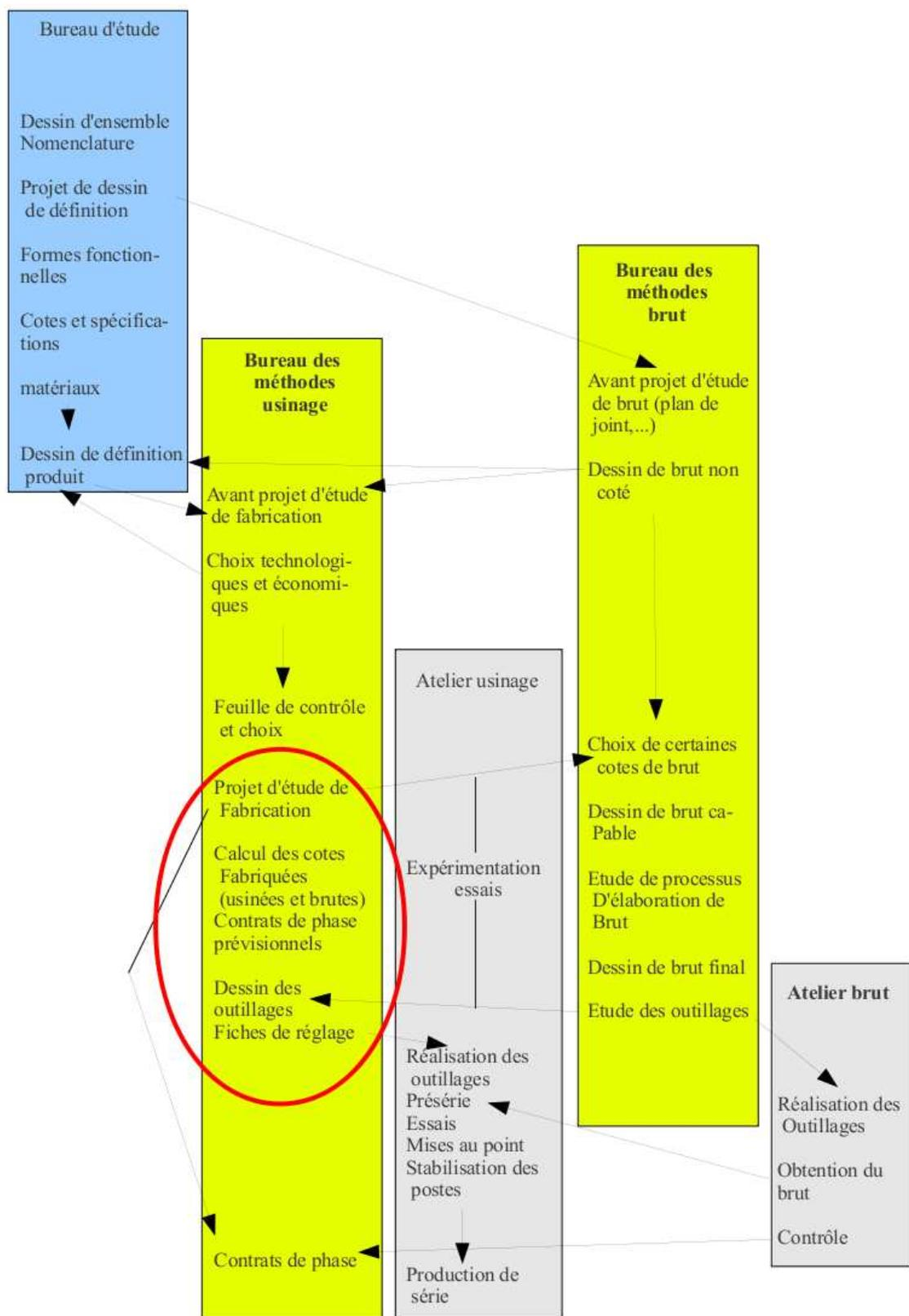
Figure 4.33: Du dessin de définition d'une pièce à la gamme de fabrication de celle-ci.
