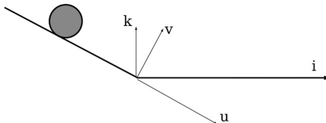
FIGURE 3.5 – Un essai de lâcher d'une bille pour mesurer le coefficient de résistance au roulement.
