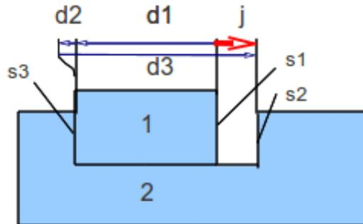
FIGURE 3.34 – Exemple d'une chaîne de cote.
