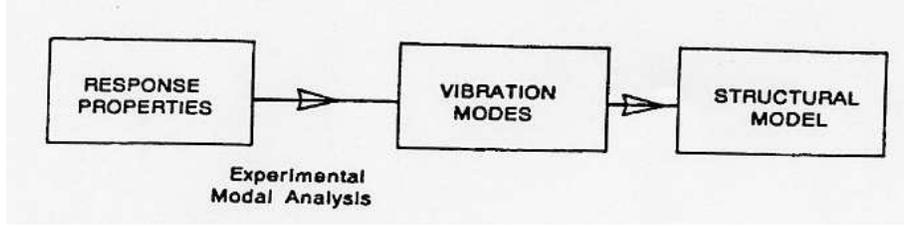
Figure 5.2: Démarche expérimentale de l'analyse vibratoire (Ewins)
