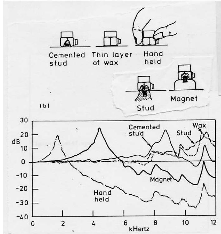
Figure 5.26: Capacités des différentes méthodes d'attache des capteurs.
