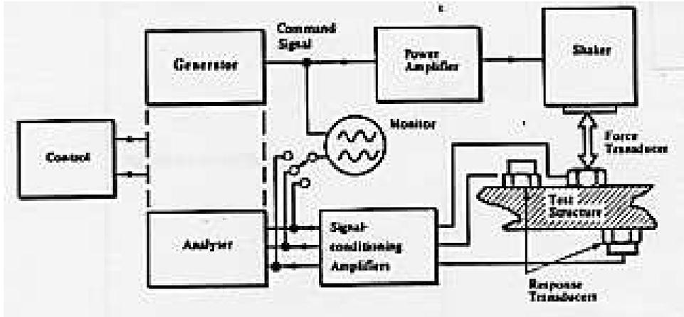
Figure 5.17: Système de mesure avec une seule excitation.
