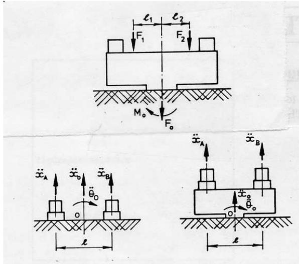
Figure 5.33: Excitation en rotation, et mesure de rotation.
