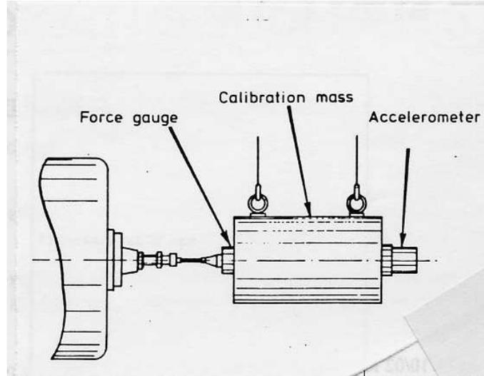
Figure 5.32: Calibration relative d'une chaîne de mesure.
