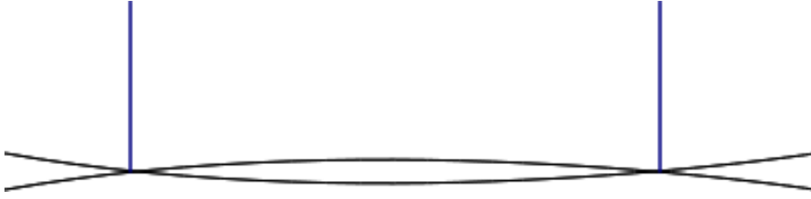
FIGURE 5.18 – Position optimale des supports de structure pour la mesure des caractéristiques vibratoires du premier mode de poutre libre-libre.
