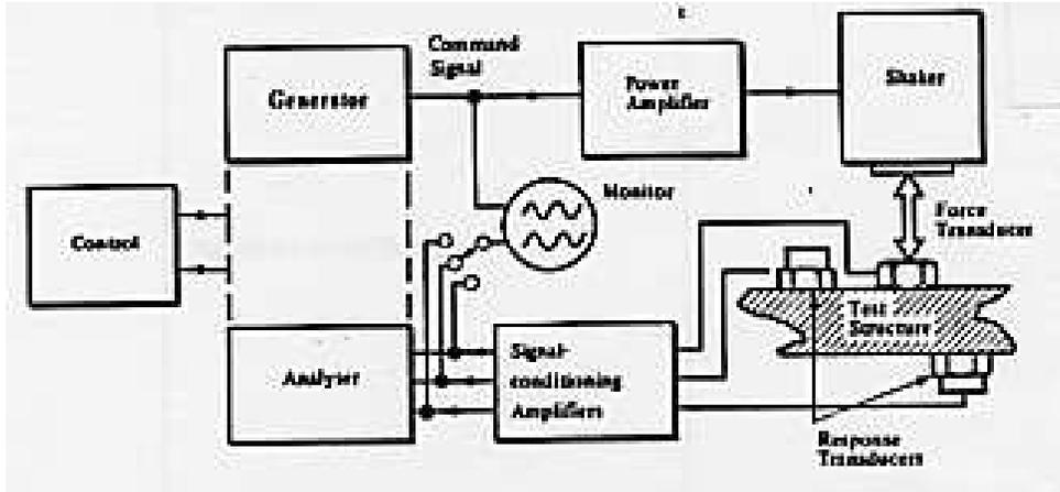
FIGURE 6.17 – Système de mesure avec une seule excitation.
