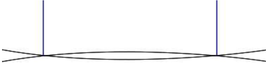
FIGURE 6.18 – Position optimale des supports de structure pour la mesure des caractéristiques vibratoires du premier mode de poutre libre-libre.
