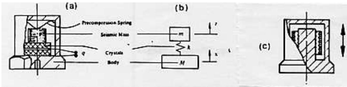
FIGURE 6.23 – Accéléromètre.
