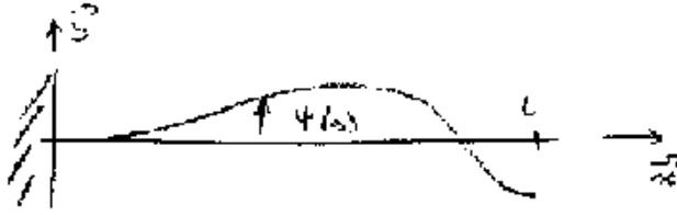
FIGURE 5.2 – Poutre encastree libre et choix d’une fonction de forme  $\psi$
