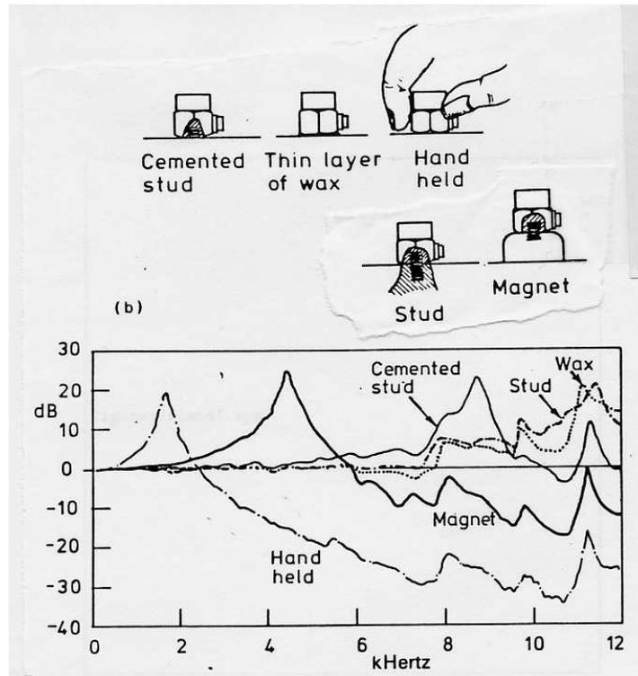
FIGURE 6.26 – Capacités des différentes méthodes d'attache des capteurs.
