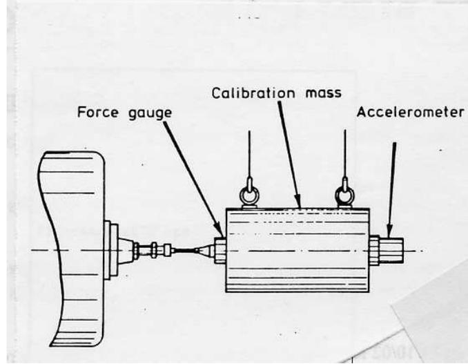
FIGURE 6.32 – Calibration relative d'une chaîne de mesure.
