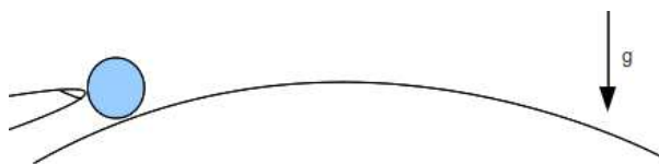
FIGURE 4.3 – Une bille, poussée jusqu’au sommet, point d’instabilité.
