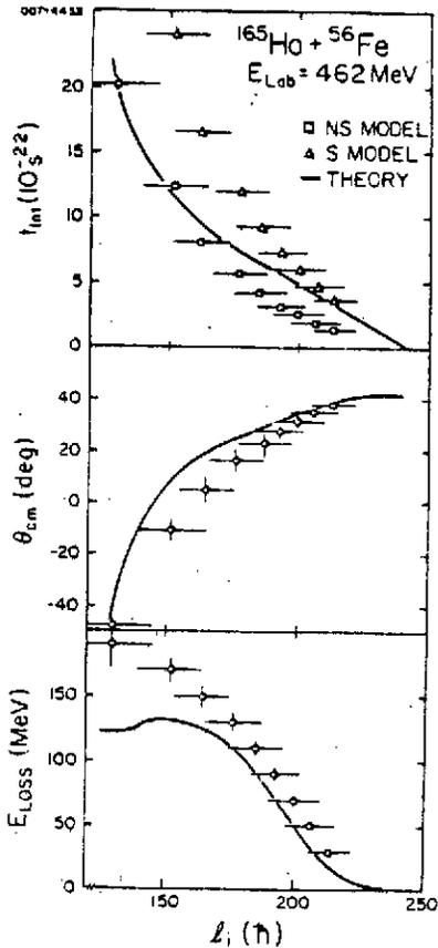
Figure 40 : Comparaison théorie (trait plein - réf. 36). Expérience (points) pour le système  $^{165}\text{Ho} + ^{56}\text{Fe}$ .  $l_i$  est le numéro de l'onde partielle moyenne associée à une perte d'énergie  $E_{\text{loss}}$  donnée.  $\theta_{\text{cm}}$  est l'angle d'émission du quasi-projectile.  $t_{\text{int}}$  est la durée de l'interaction. Les initiales NS et S sont expliquées dans le texte.
