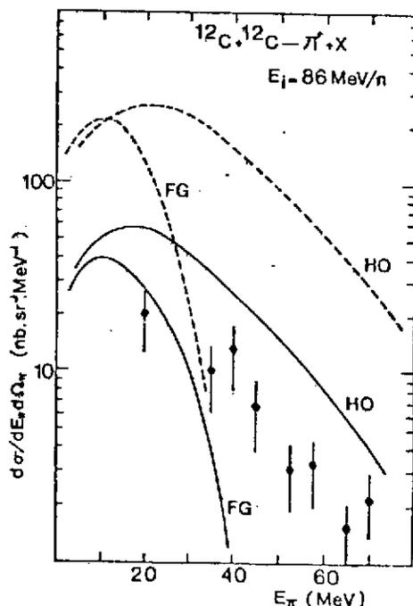
Figure 93 : Spectre en énergie des pions détectés à  $90^\circ$  pour la réaction C+C à 86 MeV/n. Ces points sont expérimentaux. Les courbes théoriques : FG : gaz de Fermi ; HO : oscillateur harmonique ; trait plein ou pointillé selon que l'on tient ou ne tient pas compte du principe de Pauli et de la réabsorption des pions.
