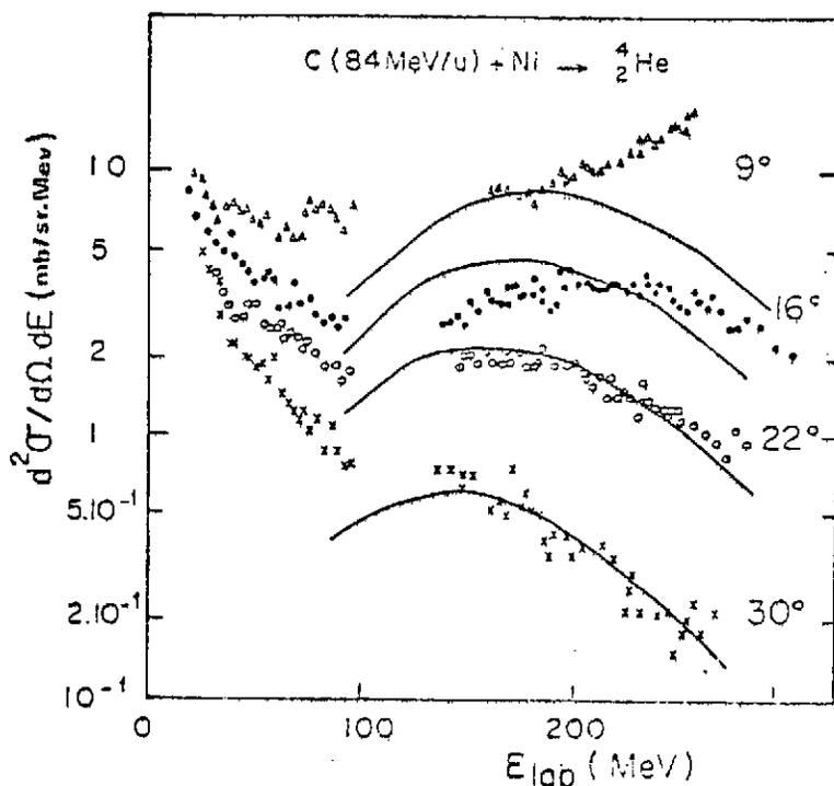
Figure 83 : Spectres en énergie des particules  $\alpha$  émises à différents angles pour le système C+Ni à 84 MeV par nucléon. Les courbes sont la contribution calculée d'une source animée de la demi-vitesse du faisceau.
