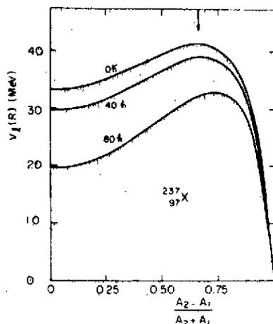
Figure 24 : Potentiel d'interaction soudain pour deux noyaux au contact en fonction de l'asymétrie des masses pour un ensemble de 97 protons et 237 nucléons. La flèche correspond au système Ar+Au.
