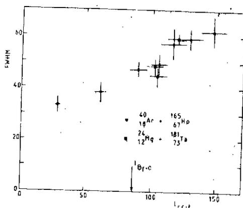
Figure 27 : Variation de la largeur à mi-hauteur de la distribution des masses avec le moment angulaire critique pour la fusion (c'est-à-dire formation noyau composé + fission rapide). Les points relatifs aux deux systèmes Mg+Ta et Ar+Ho se placent sur une même courbe ce qui est cohérent avec l'interprétation fondée sur la fission rapide.
