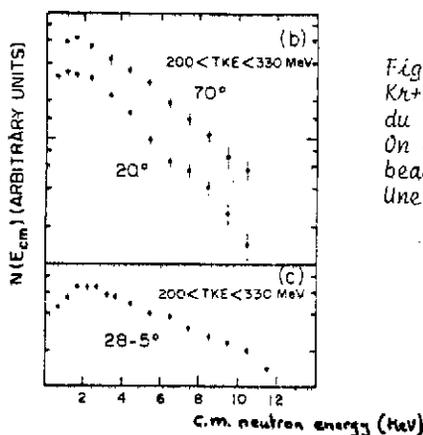
Figure 65 bis : Spectres des neutrons émis dans la réaction  $Kr+Er$  à 11,9 MeV/nucléon. A  $20^\circ$ , on a isolé la contribution du fragment léger ; à  $28.5^\circ$  et  $70^\circ$ , celle du fragment lourd. On voit que la pente du spectre associé au lourd à  $28.5^\circ$  est beaucoup plus faible que les pentes des deux autres spectres. Une composante haute énergie non évaporée en est responsable.
