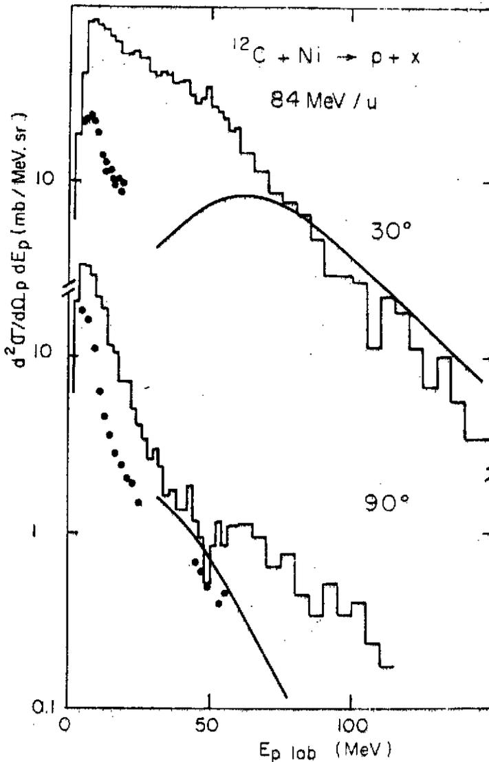
Figure 88 : Spectres en énergie des protons détectés à  $30^\circ$  et  $90^\circ$  dans la collision C+Ni à 84 MeV par nucléon. Les points sont expérimentaux. La courbe également (système C+Cu à la même énergie). Les histogrammes sont calculés. Extrait de la réf. 101.
