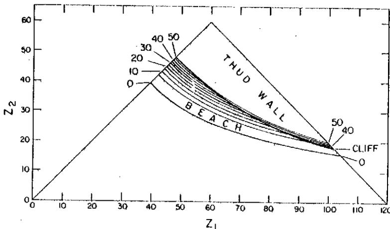
Figure 13 ; Les lignes de contours indiquent les valeurs de  $E_{xx}$  pour divers systèmes et pour  $l=0$ . Dans la zone marquée beach, on a  $E_{xx}=E_x$  (pas d'extra extra push) ; mais à partir de la frontière marquée cliff, l'extra-extra-push augmente violemment et dépasse l'extra push. (Réf. 31)
