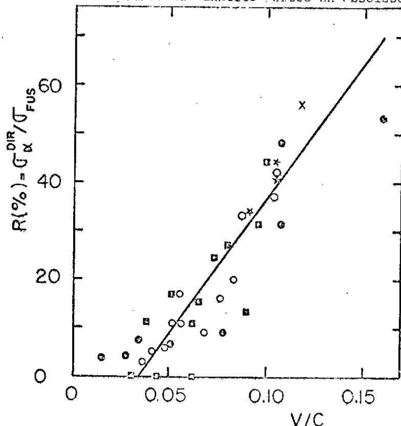
Figure 59 : Rapport entre la section efficace d'émission d' $\alpha$  directs et la section efficace de fusion en fonction de la vitesse du projectile au moment du choc. Les divers symboles correspondent à différents projectiles  $^{12}\text{C}$ ,  $^{14}\text{N}$ ,  $^{16}\text{O}$ ,  $^{35}\text{S}$ ,  $^{40}\text{Ar}$ . Il apparaît que tous les résultats se regroupent sur une même courbe (extrait de la réf. 86).
