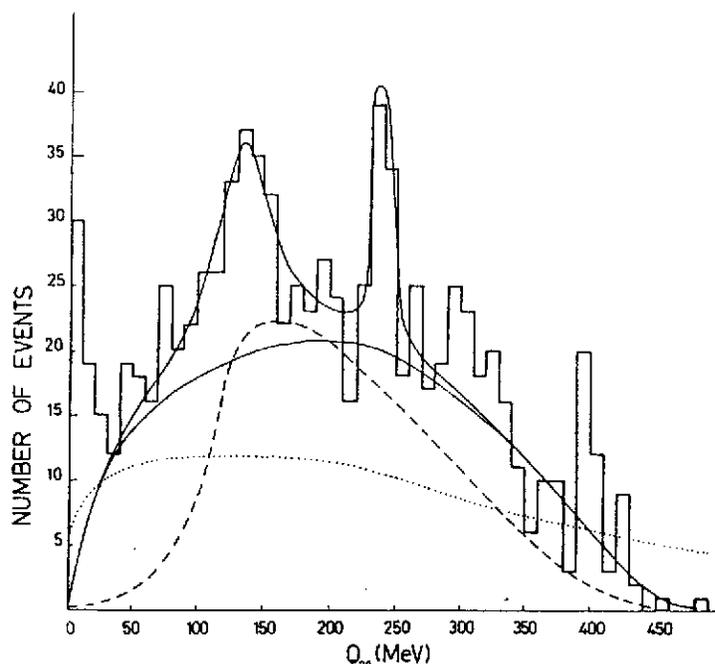
Fig. 14 - Masse invariante pn dans la réaction  $dp + (pn)p$  avec  $p_S > 350$  MeV/c [réf. 34]. Les courbes (---) et (...) représentent le fond dû à la diffusion simple et double. La courbe (—) correspond à l'espace de phase à 3 corps.
