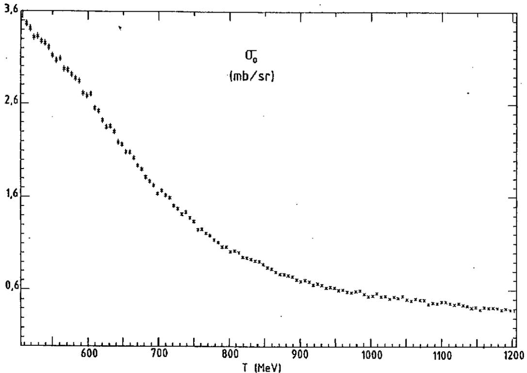
Fig. 10 - Section efficace pp à  $90^\circ$  c.m. mesurée avec un jet d'hydrogène pour cible<sup>29</sup>.
