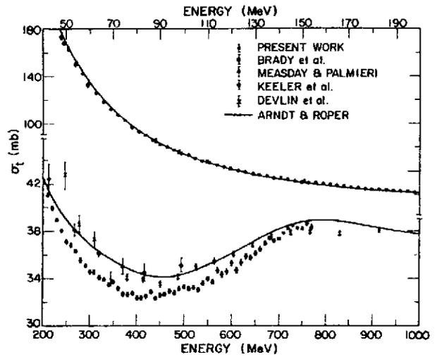
Fig. 9 - Section efficace totale  $np$  mesurée avec une source blanche de neutrons<sup>28</sup>.
