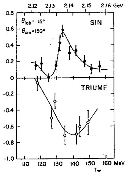
Fig. 8 - Polarisation tensorielle  $t_{20}$  du deuteron dans la diffusion  $\pi^+d$ , mesurée à la SIN et à TRIUMF.
