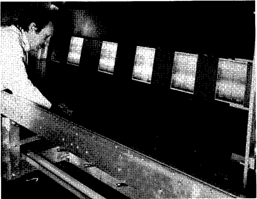
Fig. IV.23 Photographie de l'intérieur de l'enceinte, montrant la distribution des lignes équipotentielles et leur alimentation à partir du diviseur de potentiel au moyen de connexions flexibles en Kapton. La pièce centrale en aluminium, visible sur la photographie, est portée à -100 \text{ kV} .
