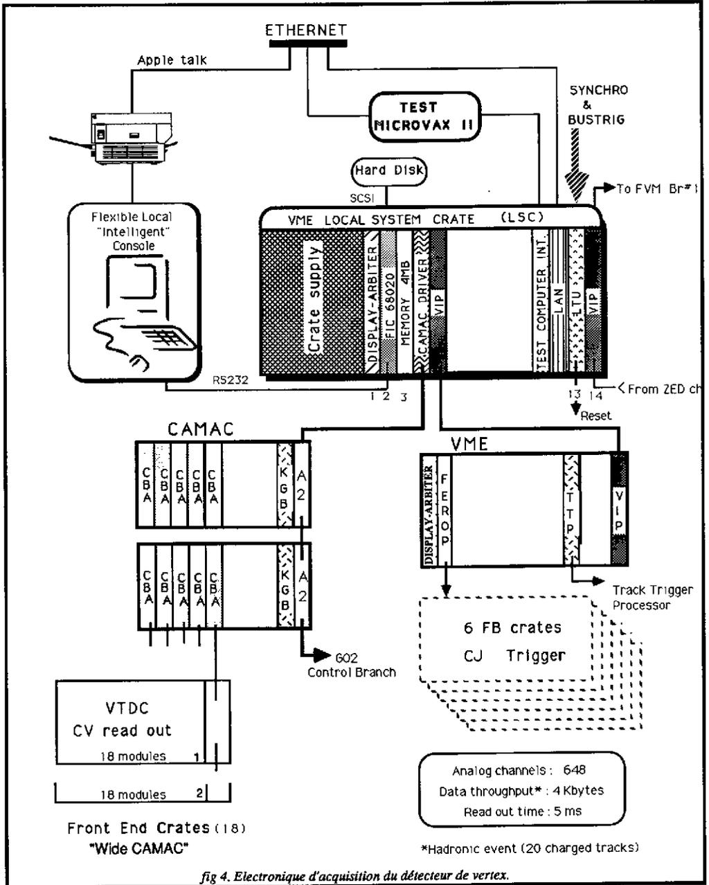
fig 4. Electronique d'acquisition du detecteur de vertex.
