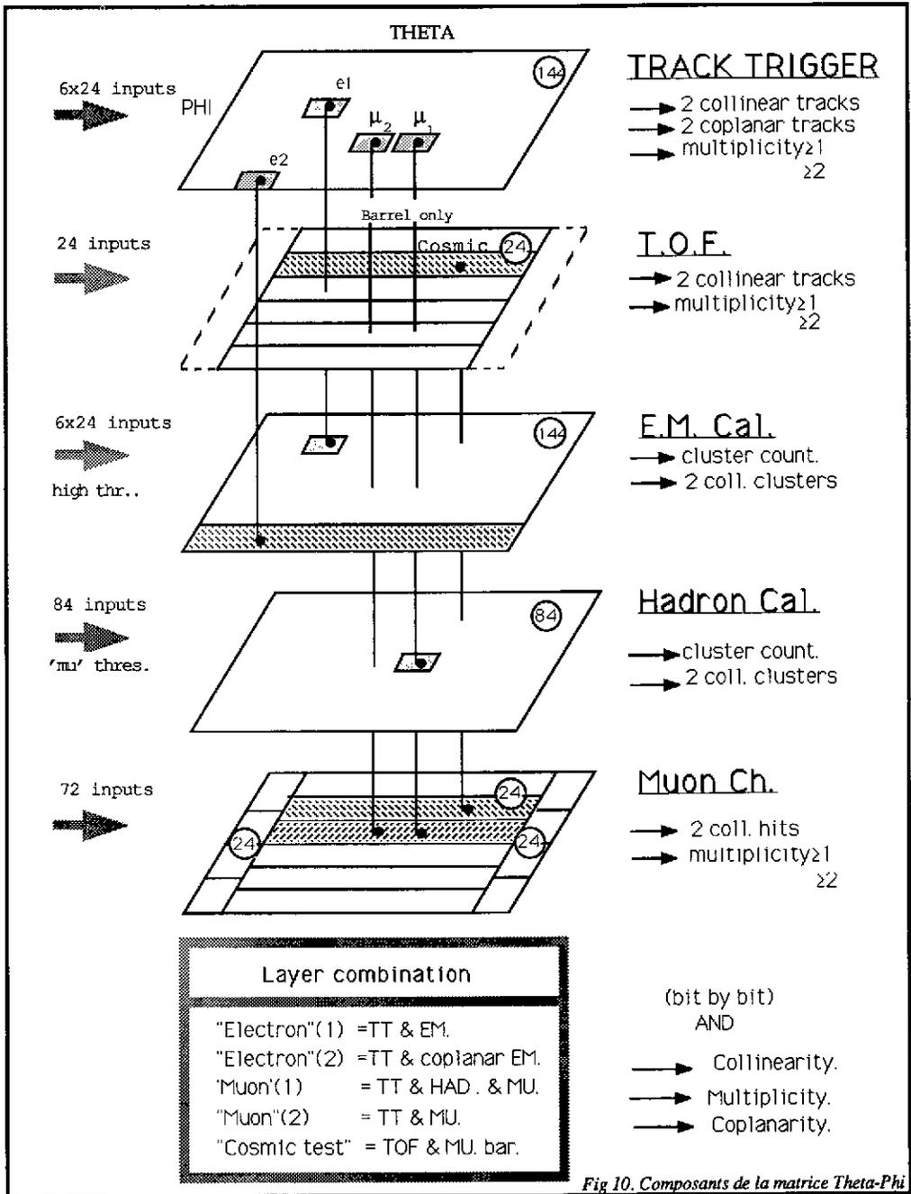
Fig 10. Composants de la matrice Theta-Phi
