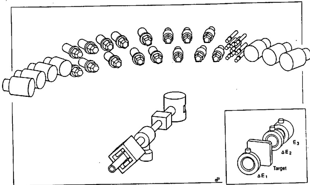
Figure 10: Dispositif expérimental pour l'étude du break-up de noyaux à halo utilisé auprès de LISE3 (voir texte du chapitre II.7).
