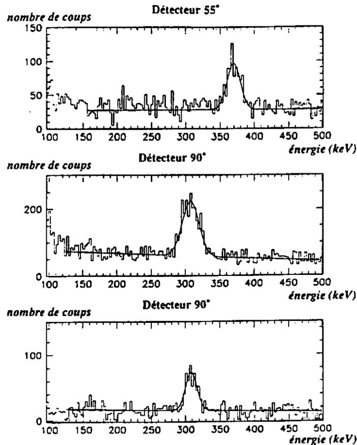
Figure 9: Spectres  $\gamma$  observés dans les détecteurs installés à  $55^\circ$  et à  $90^\circ$ , respectivement dans une configuration proche et éloignée de la cible (voir aussi Figure 8 et chapitre II.6).
