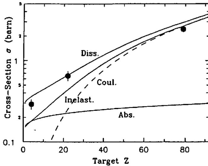
Figure 12: Sections efficaces expérimentales de dissociation pour la réaction  $^{11}\text{Be} \rightarrow ^{10}\text{Be}$  pour différentes cibles comparées aux contributions calculées (voir texte du chapitre II.7)
