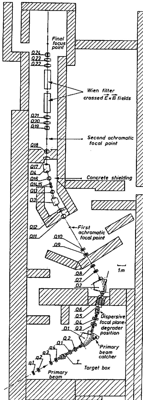
Figure 3: Le spectromètre LISE du GANIL. L'extension au-delà du premier point focal achromatique ("LISE") a été construite en 1992.  $q_{1-4}$  et  $Q_{1-24}$  sont des quadrupoles de focalisation en amont et en aval de la cible, respectivement.  $D_1$  et  $D_2$  d'une part et  $D_3$  et  $D_4$  d'autre part, sont des dipôles magnétiques qui assurent le double achromatisme de l'ensemble de LISE3.
