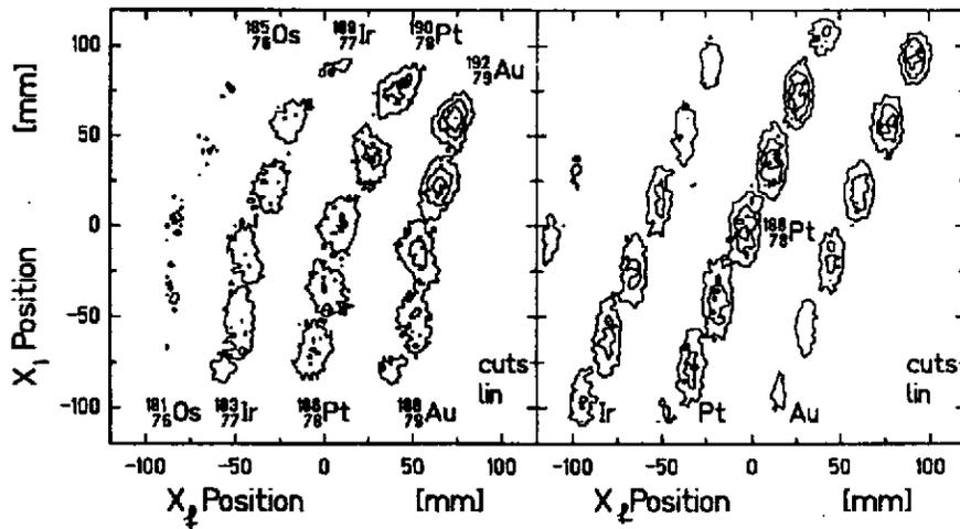
Fig 17: séparation mesurée (à gauche) et calculée (à droite) de fragments au FRS\_GSI produits avec un faisceau <sup>197</sup>Au de 1GeV/nucléon. Le dégradeur était Al (1.4g/cm<sup>2</sup>).
