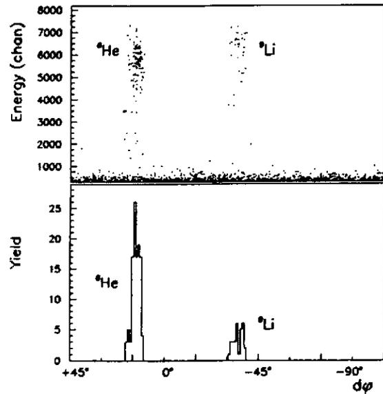
fig 29: identification après accélération à un rayon de 3m. Noter la disparition complète de  $^{15}\text{N}$ . La différence de phase entre  $^6\text{He}$  et  $^9\text{Li}$  est une mesure directe de leur différence de masse.
