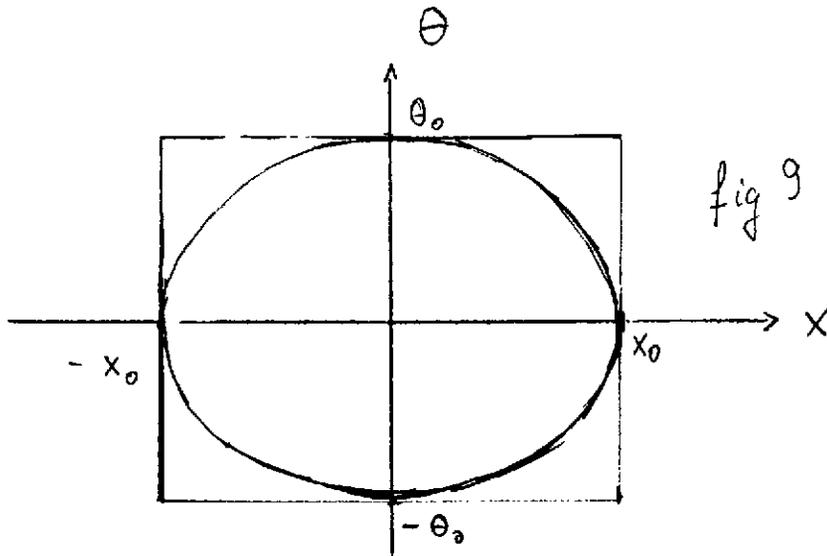
Les particules peuvent venir de n'importe quel point de cette figure d'émittance, délimité par  $\pm x_0$  et  $\pm \theta_0$ . Souvent ce rectangle est remplacé par une ellipse, avec la surface  $\mathcal{E}_h = \pi x_0 \theta_0$ .
