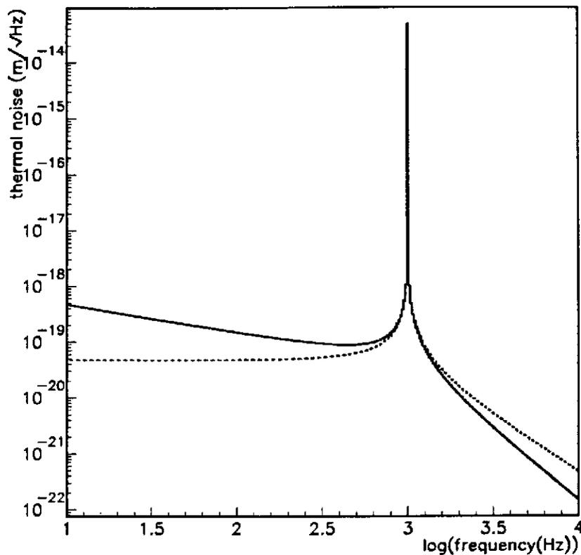
Figure 16: Densité spectrale d'amplitude de bruit thermique pour les deux mécanismes de dissipation. Trait uni: amortissement interne, trait pointillé: amortissement visqueux. Dans les deux cas on a pris  $m = 30 \text{ kg}$ ,  $T = 300 \text{ K}$ ,  $\omega_0 = 2\pi \times 1 \text{ kHz}$  et  $Q = 10^6$ .
