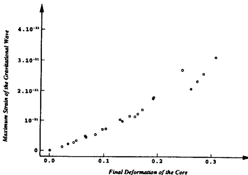
Figure 2: Amplitude maximale d'OG émises par une supernova de type II à 1 Mpc en fonction de la déformation finale du coeur pour différents scénarios et conditions initiales, d'après Bonazzola et Marck<sup>(2)</sup>.
