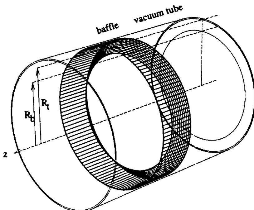
Figure 13: Un piège à lumière conçu dans VIRGO.
