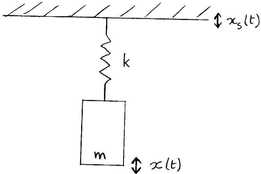
Figure 10: Masse suspendue au bout d'un ressort. Son mouvement est décrit par  $x(t)$ , les vibrations du sol par  $x_s(t)$ .
