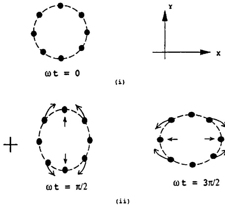
Figure 1: Effet d'une OG sur un cercle de masses d'épreuve. L'incidence est l'onde est normale au plan des masses.
