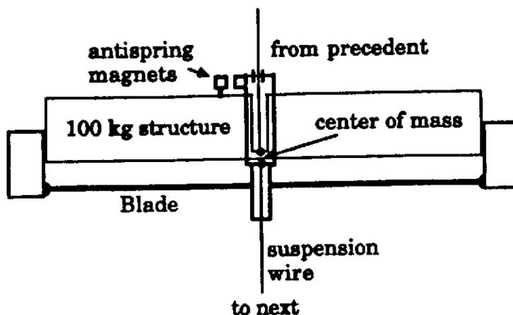
Figure 11: Schéma d'un atténuateur sismique.
