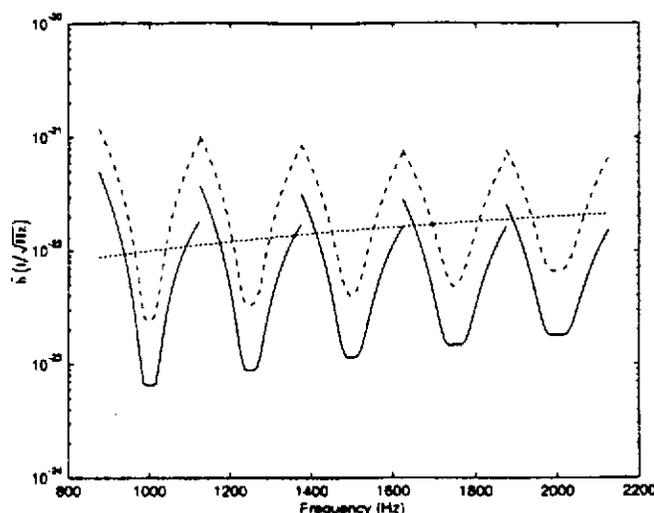
Figure 7: Sensibilités comparés d'un xylophone de TIGAs à la limite quantique (trait plein), d'un xylophone de barres traditionnelles à la limite quantique (tirets) et du détecteur interférométrique LIGO (limité par le bruit de photons à ces fréquences (pointillés)<sup>13</sup>)
