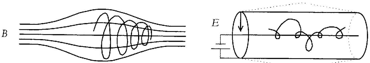
Figure 3 : Pièges statiques : (à gauche) la bouteille magnétique (à droite) le piège électrostatique de Kingdon.
