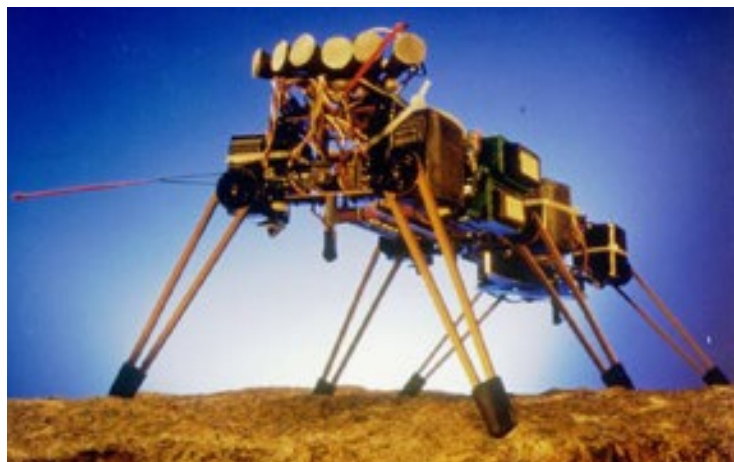
FIGURE 1.5 – Genghis, développé par Rodney Brooks au MIT au début des années 1990.
