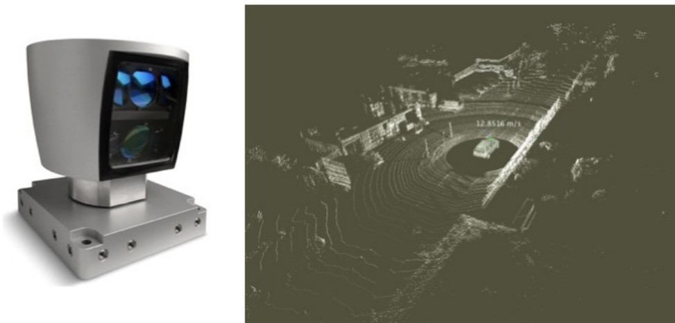
FIGURE 4.13 – Un exemple de télémètre laser à balayage à 64 nappes conçu par Velodyne.
