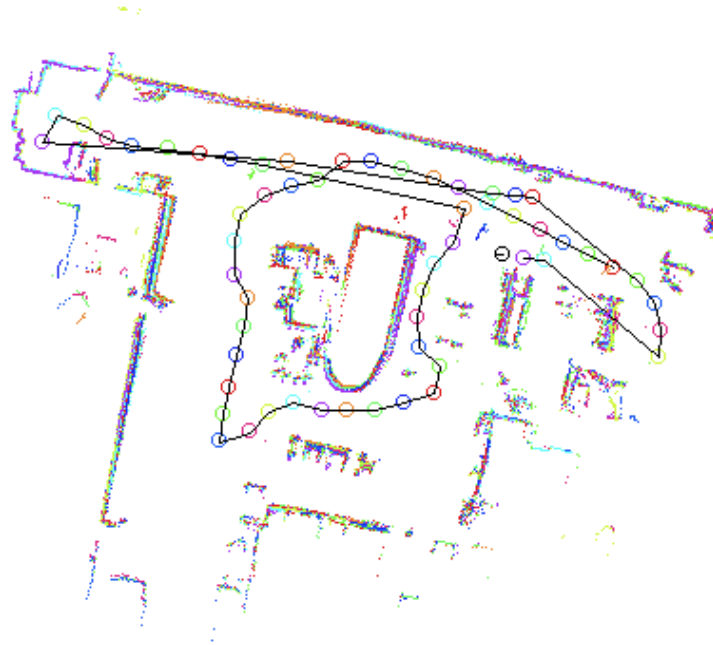
FIGURE 11.4 – Exemple de carte métrique créée par corrélation de scans. Chacun des cercles relié par une ligne indique le centre d'un scan ajouté à la carte (repris de [32]).
