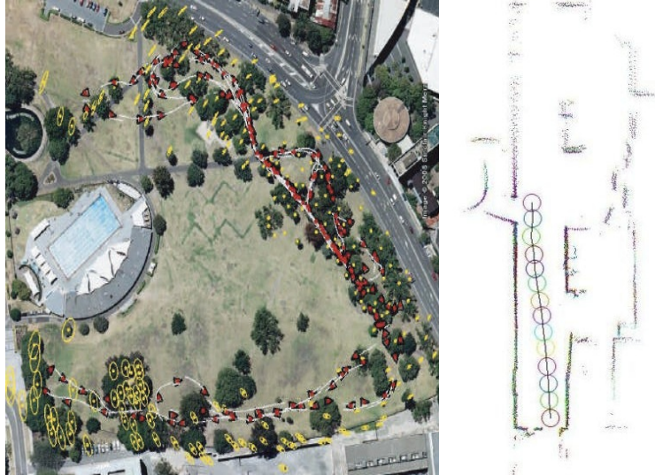
FIGURE 9.3 – Exemples de cartes métriques à base de points isolés (on parle alors d'amers, à gauche, repris de [109]) et de carte à base de scans lasers (chaque cercle est le centre d'un scan laser regroupant les points de la même couleur, à droite).
